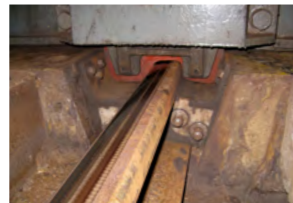
DETAIL TLAKOVÉHO UZÁVĚRU V MÍSTĚ TĚSNĚNÍ KOLEJNICE
