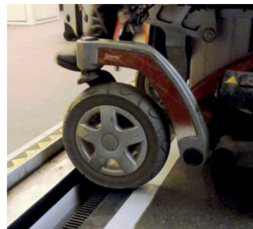
ZKOUŠKA POJEZDU ELEKTRICKÉHO INVALIDNÍHO VOZÍKU PO PROFILU ŠÍŘKY 90 MM U VOZU TYPU 81-71M VE STANICI ANDĚL
