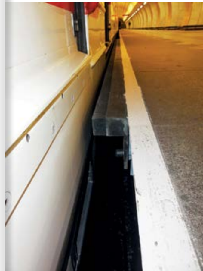
PROFIL GAP FILLER O ŠÍŘCE 90 MM, POHLED PODÉL VOZU TYPU 81-71M
