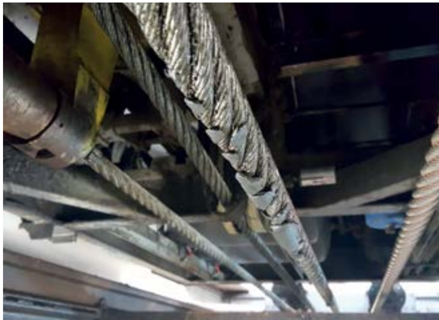
DETAIL BRZDNÉHO LANA S MAZIVEM ELASKON
