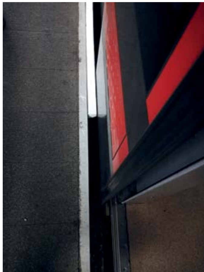
ZKOUŠKA S POLYSTYRÉNOVÝMI BLOKY ŠÍŘKY 50 MM U VOZU TYPU M1 VE STANICI KAČEROV
