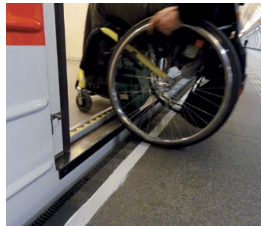
ZKOUŠKA POJEZDU MECHANICKÉHO INVALIDNÍHO VOZÍKU PO PROFILU O ŠÍŘCE 90 MM U VOZU TYPU 81-71M
