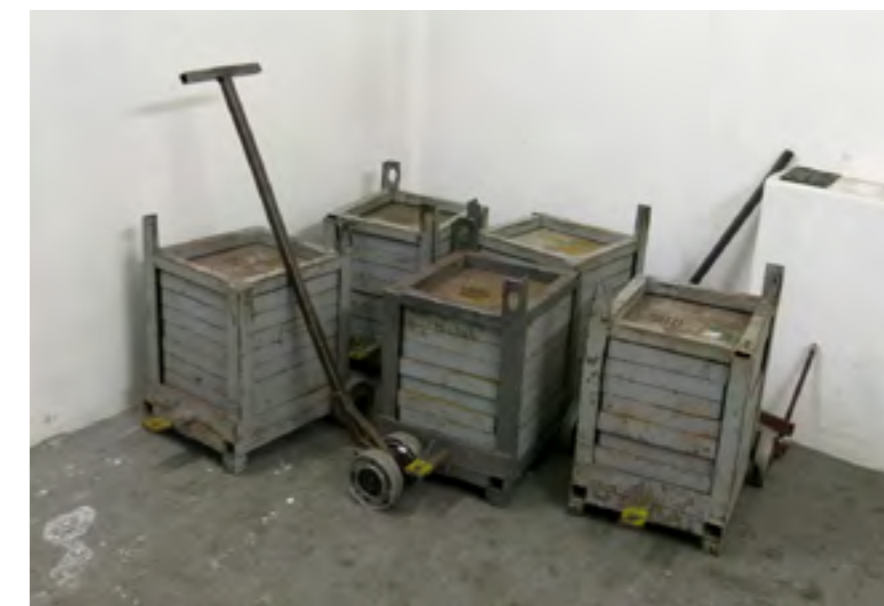
ZÁVAŽÍ POUŽÍVANÁ PŘI PROHLÍDKÁCH A ZKOUŠKÁCH VÝTAHŮ
