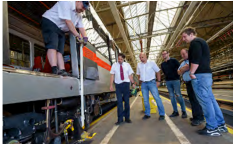
NÁZORNÁ UKÁZKA ODTLAČENÍ SBĚRAČE NA SOUPRAVĚ M1
