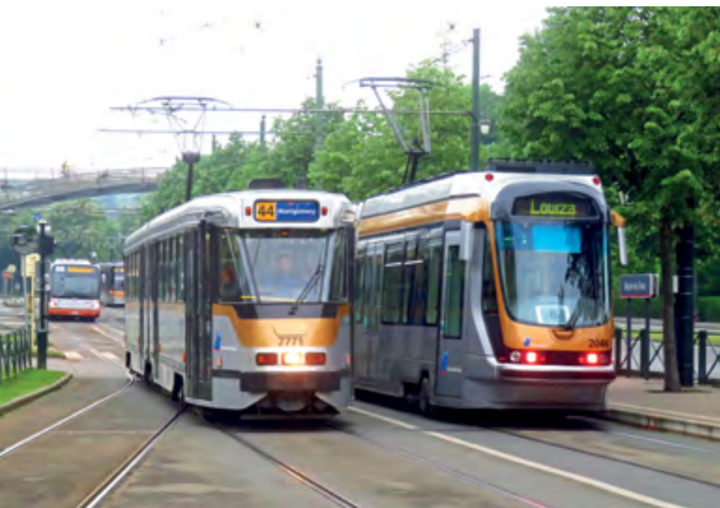
MÍJENÍ KLASICKÉ BRUSELSKÉ TRAMVAJE BN PCC Z ROKU 1972 (VLEVO) S JEDNOU Z PRVNÍCH NÍZKOPODLAŽNÍCH TRAMVAJÍ TYPU T2000 Z ROKU 1995
