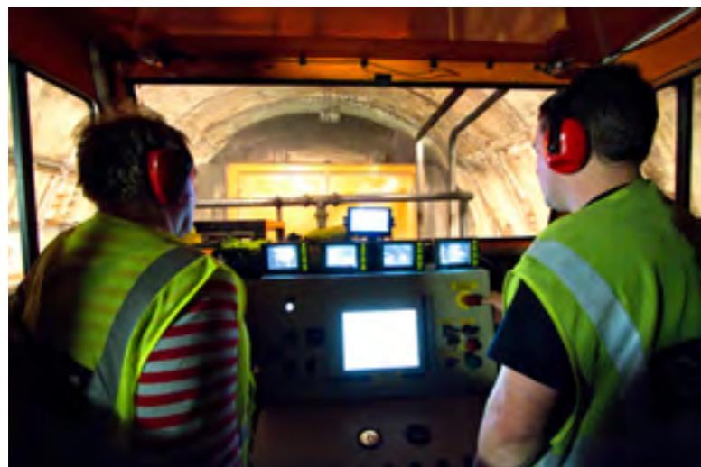
POHLED Z KABINY ČISTIČÍ TUNELOVÉ SOUPRAVY TWS30
