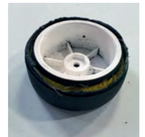
STEJNĚ JAKO NA REÁLNÉM OKRUHU MŮŽE I NA ZMENŠENÉM DOJÍT K DEFEKTU PNEUMATIKY
