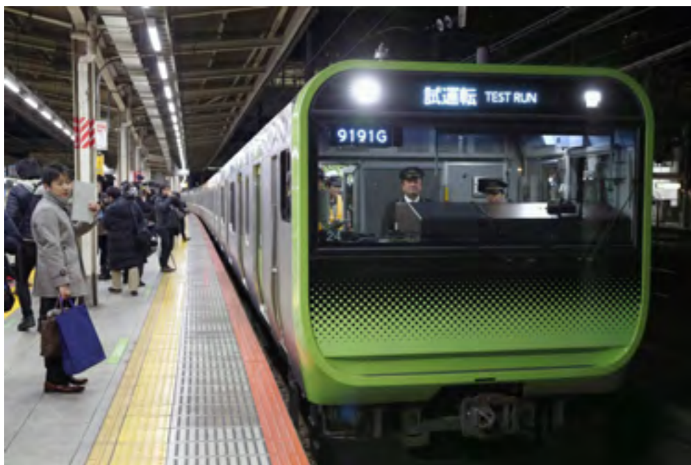
TESTOVACÍ PROVOZ AUTONOMNÍHO VLAKU E235 NA TRATI LINKY YAMANOTE V TOKIU ZDROJ: JAPANTIMES.CO.JP
