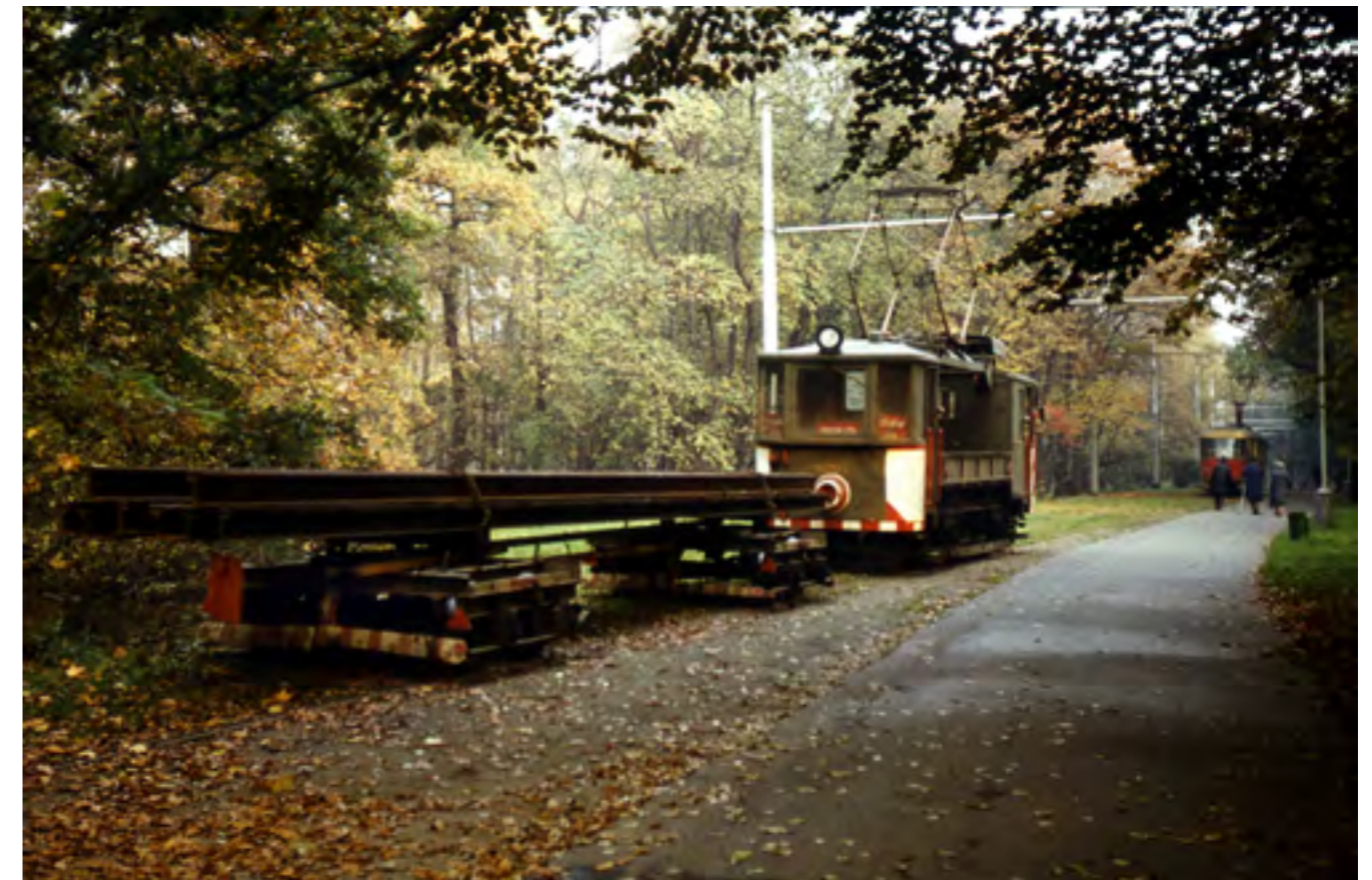
NÁKLADNÍ MOTOROVÝ VŮZ 4005 ZACHYTL FOTOGRAF 17. ŘÍJNA 1977 NA KONCI KUSÉ KOLEJE S VOZÍKY NA PŘEPRAVU KOLEJNIC
