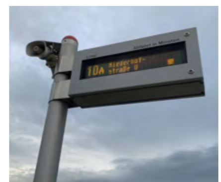
PŮVODNÍ PANEL ZASTÁVKOVÉHO INFORMAČNÍHO SYSTÉMU S ONLINE ODJEZDY AUTOBUSOVÝCH SPOJŮ V ZASTÁVCE SCHLOSS SCHÖNBRUNN. PROBLIKÁVAJÍCÍ SYMBOL ČTVERCE NAZNAČUJE, ŽE SPOJ PŘÁVĚ PŘIJÍŽÍ
