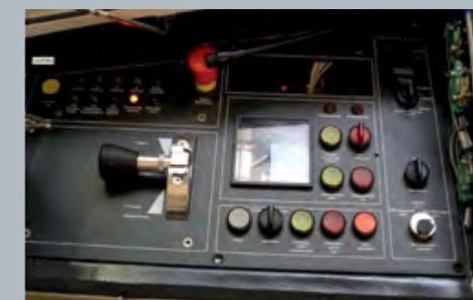
DETAIL NOUZOVÉHO PULTU ŘÍZENÍ SOUPRAVY SIEMENS DT3 (LEVÝ A PRÁVÝ)
