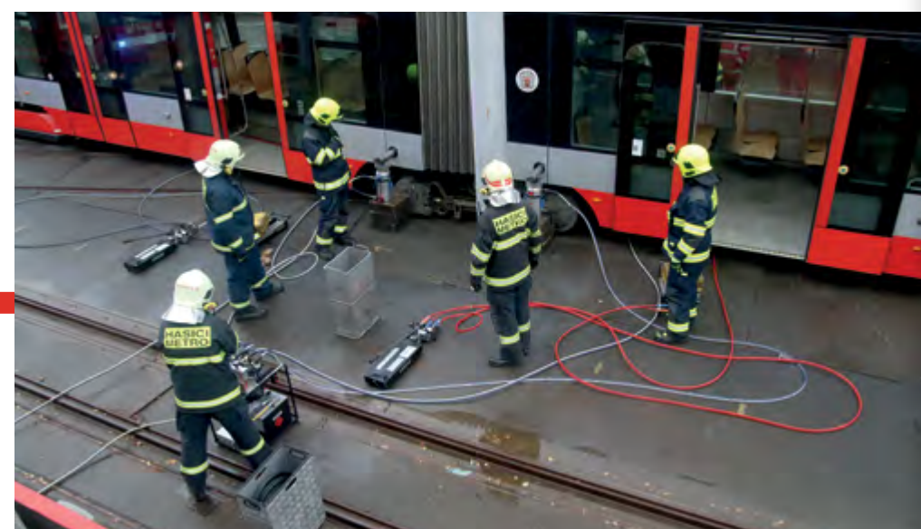
ZÁSAH Č. 551, HOSTIVAŘ – VYKOLEJENÁ TRAMVAJ – SRÁŽKA DVOJICE TRAMVAJÍ; PROVEDENO ZVEDNUTÍ TRAMVAJE A NAKOLEJENÍ VYKOLEJENÝCH PODVOZKŮ POMOCÍ HYDRAULICKÉHO ZAŘÍZENÍ LUKAS
