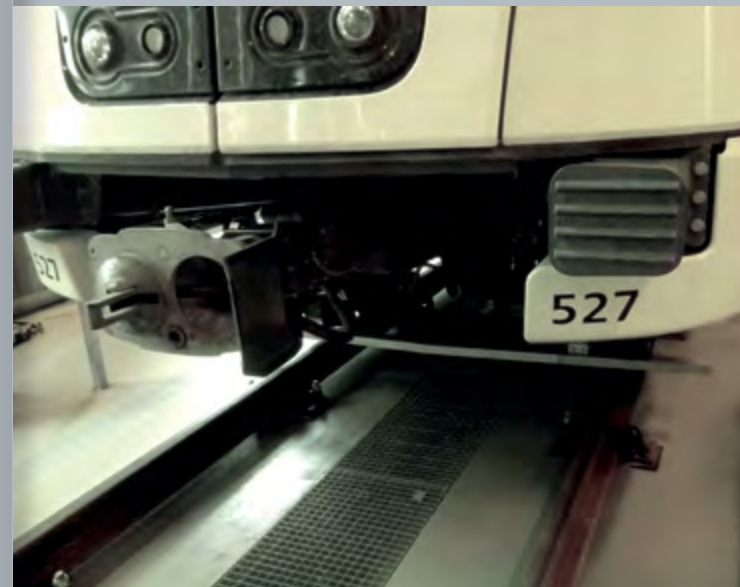
DETAIL DETEKCE PŘEKÁŽEK U DT3 (VLEVO) A U SOUPRAVY AM4-M4
