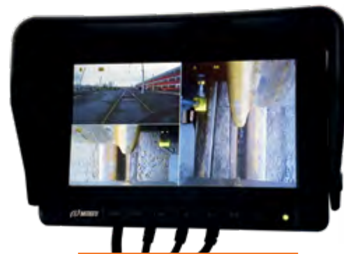
DISPLEJ V KABINĚ ŘIDIČE – DETAIL NAKOLEJOVÁNÍ
