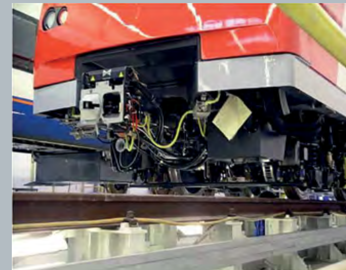
DETAIL DETEKCE PŘEKÁŽEK U DT3 (VLEVO) A U SOUPRAVY AM4-M4
