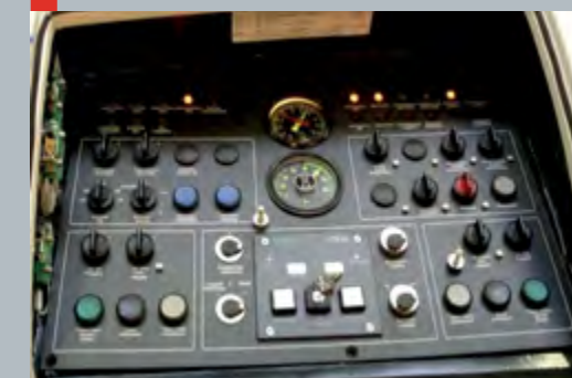
DETAIL NOUZOVÉHO PULTU ŘÍZENÍ SOUPRAVY SIEMENS DT3 (LEVÝ A PRÁVÝ)
