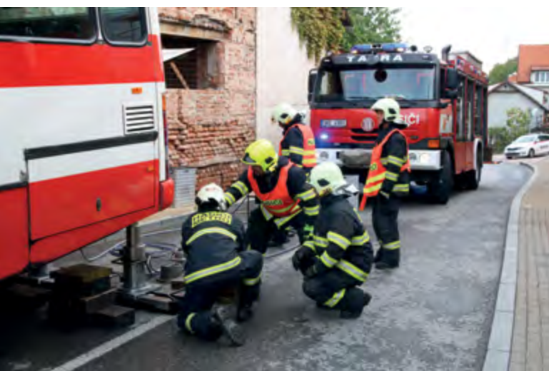
ZÁSAH Č. 457, LIPENCE – NAVZÁJEM ZAKLÍNĚNÉ KLOUBOVÉ AUTOBUSY V ÚZKÉ KOMUNIKACI; PROVEDEN BOČNÍ POSUN AUTOBUSU POMOCÍ HYDRAULICKÉHO ZAŘÍZENÍ LUKAS, AUTOBUSY OSVOBOZENY
