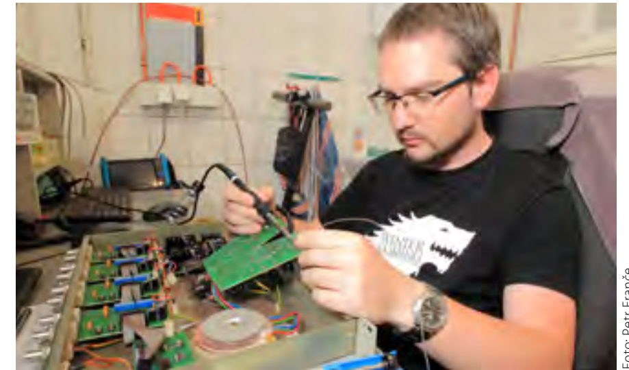
JAN KRIEGER ZE STŘEDISKA CCTV OPRAVUJE JEDNOTKU NAPÁJENÍ PRO ANALOGOVÉ KAMERY
