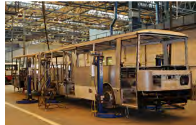
BŘEZEN 2018: OPLECHOVANÁ PŘEDNÍ ČÁST
