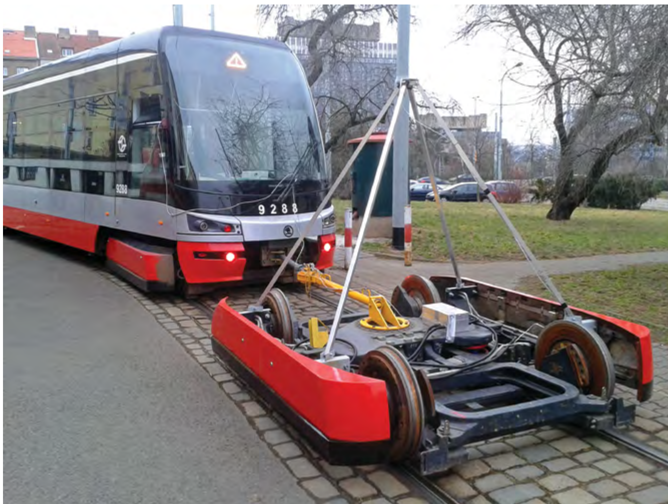
PRO DIGITALIZACI TRAMVAJOVÝCH TRATÍ UPRAVENÝ MANIPULAČNÍ PODVOZEK VOZIDLA TYPU 15T. SÍŤ ZMAPOVAL BĚHEM ROKU 2016
