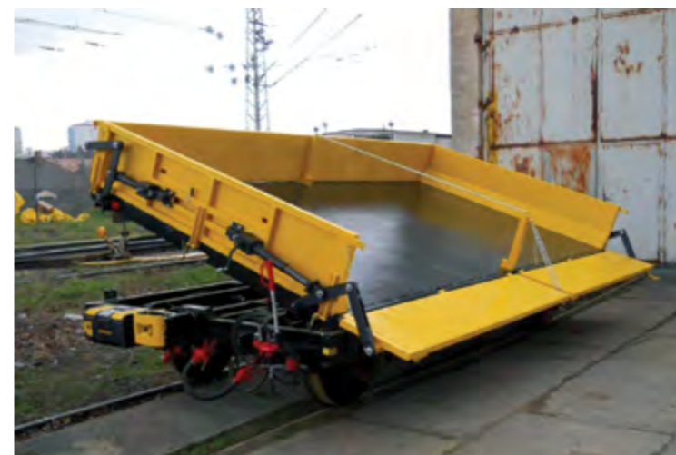
UPRAVENÉ BOČNICE VOZÍKU Pvk 82 PRO PŘESNÉ SMĚROVÁNÍ VYKLÁPĚNÉHO MATERIÁLU
