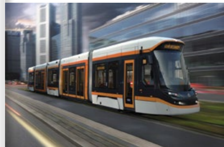
TRAMVAJ FORCITY CLASSIC S KOMBINACÍ PANTOGRAFU A BATERIOVÉHO POHONU (PRO TURECKÉ MĚSTO ESKIŞEHİR). FOTO: SKODA.CZ
