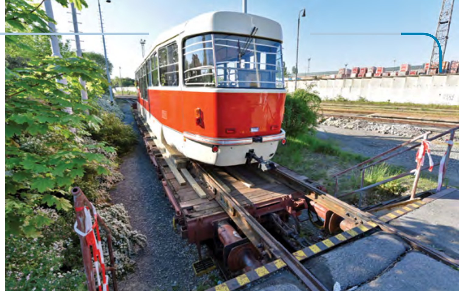
PŘÍPRAVA NA PŘETAH VOZU Č. 8284 Z PLOŠINOVÉHO VAGONU NA TRAMVAJOVÉ KOLEJE U PŘEKLÁDACÍ RAMPY V ŽST. PRAHA-ZLIČÍN NEDELEKO TRAMVAJOVÉ SMYČKY SÍDLIŠTĚ ŘEPY. NA PLOŠINOVÉM VOZE BYL VŮZ USAZEN NA VYRAZENÝCH PANELECH BKV (19. 5. 2017)
