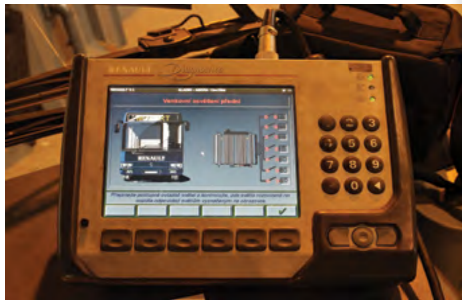
VŠECHNY PARAMETRY JE TŘEBA SPRÁVNĚ NASTAVIT POMOCÍ DIAGNOSTICKÉHO NÁSTROJE RENAULT (30. 3. 2017)
