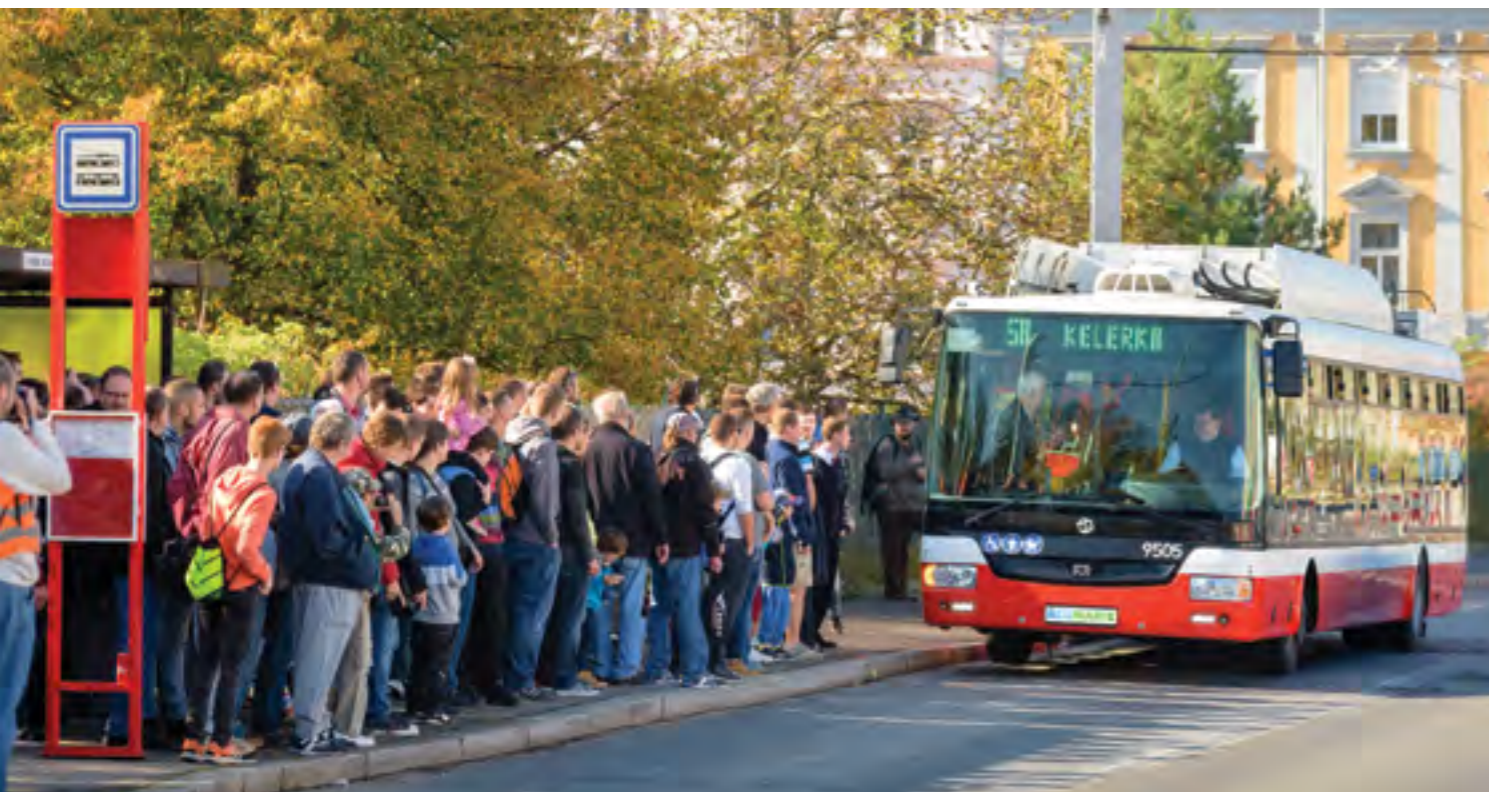
ELEKTROBUS S DYNAMICKÝM DOBÍJENÍM JE NOVÝM PROJEKTEM DPP, ZKOUŠENÝM V ULICI PROSECKÁ
