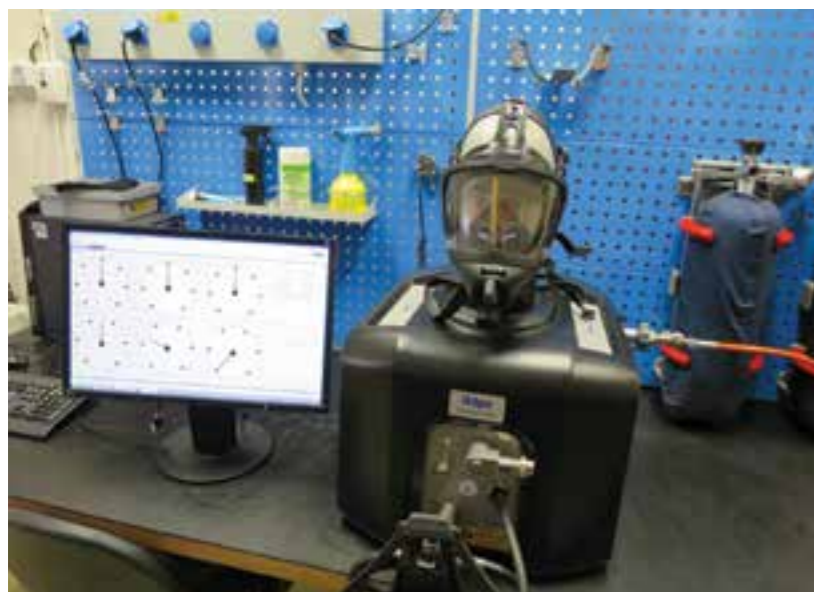
TESTOVÁNÍ KYSLÍKOVÉ MASKY FPS 7000 NA ZKUŠEBNÍ HLAVĚ QUAESTORU
