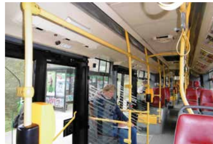
FYZIKALNÍ OVĚŘOVÁNÍ PŘESNOSTI APC PROBÍHÁ ZA PŘÍTOMNOSTI 1 SČÍTAČE U KAŽDÝCH DVEŘÍ VOZIDLA. PRO ZAJIŠTĚNÍ MAX. PŘESNOSTI FYZICKÉHO SČÍTÁNÍ JE VHDNĚ KE VŠEM PROSTŘEDNÍM DVEŘÍM NASADIT 2 SČÍTAČE (PRVNÍ SLEDUJE POUZE NÁSTUP CESTUJÍCÍCH, DRUHÝ SLEDUJE POUZE VÝSTUP CESTUJÍCÍCH – V SOULADU S NORMOU VDV-SCHRIFT 457)
