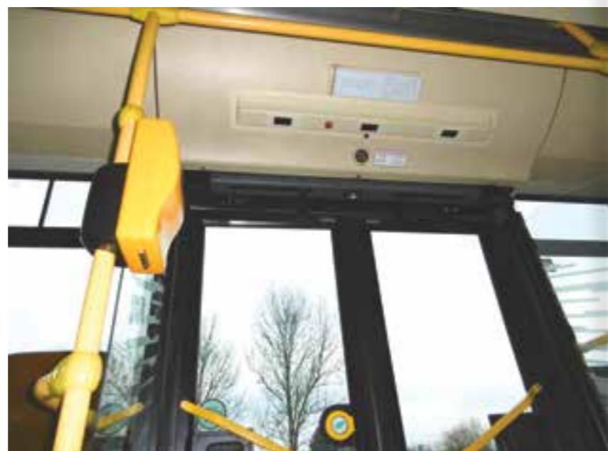
PŘÍDAVNÁ PLASTOVÁ LIŠTA NAD DVEŘMI AUTOBUSU S TŘEMI OBOUSMĚRNÝMI ČIDLY DILAX – BAREVNĚ SLADĚNO S INTERIÉREM VOZU
