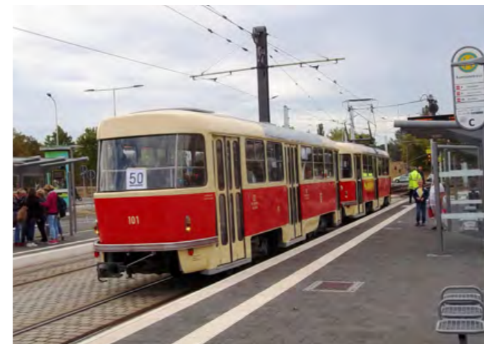
HISTORICKÁ SOUPRAVA T4D + B4D SLOŽENÁ Z VOZŮ Č. 901 (EX 924) + 101. VLEČNÝ VŮZ B4D VYCHÁZÍ KONSTRUKČNĚ Z VOZU T4D, ALE NENÍ MOTORIZOVANÝ
