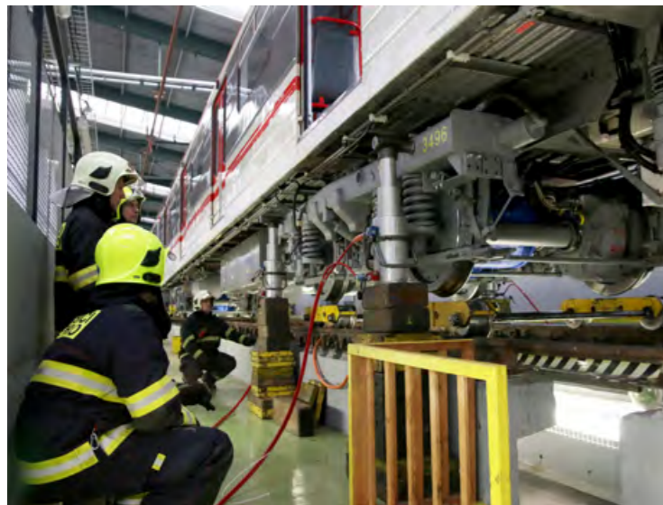
ULOŽENÍ SOUPRAVY 81-71M NA HAVARIJNÍ PODVOZEK, DEPO HOSTIVÁŘ, 27. 3. 2019
