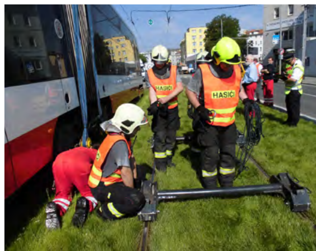
NAKOLEJENÍ A ULOŽENÍ TRAMVAJE 15T NA HAVARIJNÍ PODVOZEK, UL. KOLBENOVA, 4. 6. 2019
