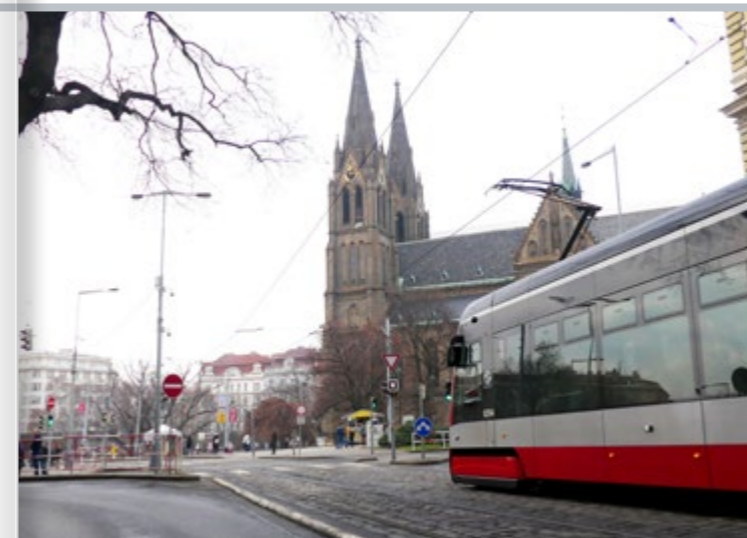
PREFERENCI TRAMVAJÍ BYLA V ROCE 2019 ZAVEDENA TAKÉ NA HORNÍ KŘIŽOVATCE NA NÁMĚSTÍ MÍRU. TRAMVAJOVÉ SIGNÁLY VOLNO PADAJÍ POUZE NA VÝZVU TRAMVAJE, VE ZBYLÉM ČASE SVÍTÍ PŘES KOLEJE TRVALE VOLNO PRO CHODCE
