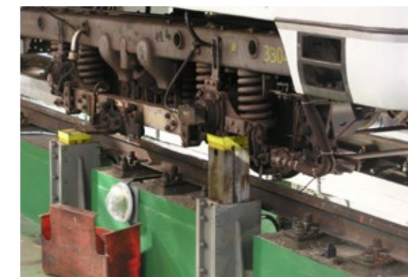
FOTOGRAFIE ZACHYCUJE PŘVOTNÍ ZKOUŠKY VLIVU MODIFIKÁTORU ADHEZE NA BRZDĚNÍ TŘECÍ ŠPALÍKOVOU BRZDOU VOZŮ 81-71M. ZKOUŠKY SE V TUTO CHVÍLI PROVÁDĚLY NA JEDNOM VYHEVEROVANÉM VOZU VE ZKUSĚBNĚ OPRAVÁRENSKÉ ZÁKLADNY METRA (OZM)
