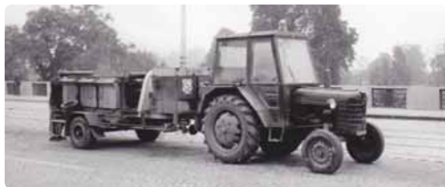
Ve své době častý obrázek v pražských ulicích. Jde o zalévání spár v dlažbě asfaltem. Příslušnost k vozidlům DP Praha není na první pohled zřejmá, protože traktor není opatřen evidenčním číslem. Onen přivěšený asfaltovací agregát však prokazuje zařazení do vozového parku zmíněného dopravce zcela přesvědčivě označením DP 1152. Nacházíme se na Hlávkově mostě, a to v době, kdy na něm byl automobilový provoz stále ještě zcela neporovnatelný s dnešní realitou. 9. 10. 1978.
