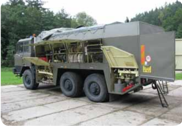
Ukázka armádního dekontaminačního automobilu ACHR 90 - T 815.
