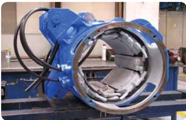
Rekonstruovaná skříň motoru s novými póly a kabeláží.
