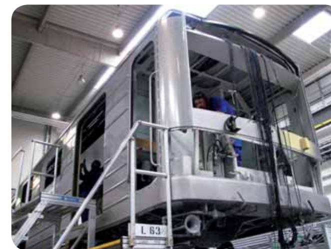
Montáž vybavení kabiny strojvedoucího
