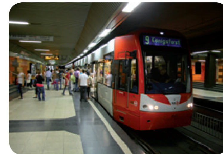
Podzemní zastávka Bf Deutz / Messe pro nízkopodlažní tramvaje. Nástupní hrana má 35 cm
