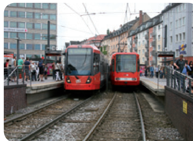
Vysoké perony mají nástupní hranu ve výšce 90 cm. Na snímku jsou vozy Bombardier Flexity Shift (vlevo) a Düweg na zastávce Bf Deutz
