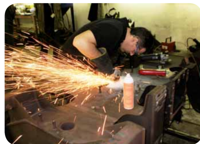
Svářeč společnosti ESAB Vamberk Rudolf Hrabina vybrušuje trhlinu na příčniku rámu
