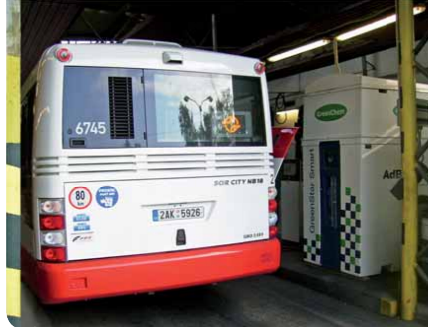
SOR NB18 v garáži Klíčové při doplňování přípravku AdBlue pro omezení emisí v rámci limitu Euro 5 (ev. č. 6745, v provozu od 9/2011, najeto 23 tis. km)
