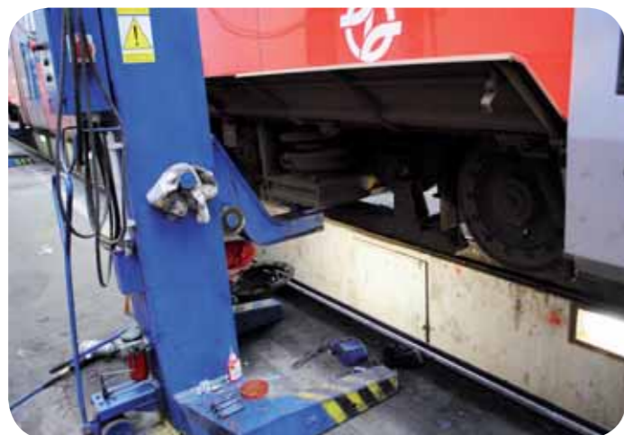
Před výměnou kola je tramvaj zvednuta na hydraulických heverech
