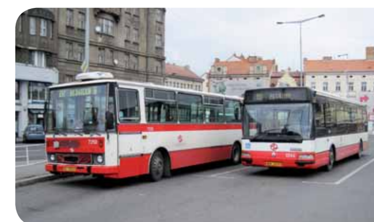
Autobusy Karosa B731.1659, ev. č. 7250 (v provozu od 9/1995, najeto 994 tis. km) a Karosa Citybus 2070.24, ev. č. 3246 (v provozu od 10/1999, najeto 921 tis. km) v obřatišti Na Knížecí
