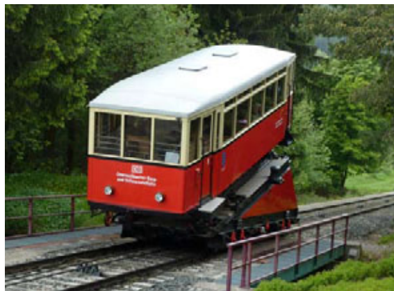
Jeden z vozů lanovky Oberweissbacher Bergbahn – plošina na přepravu železničních vozů.
