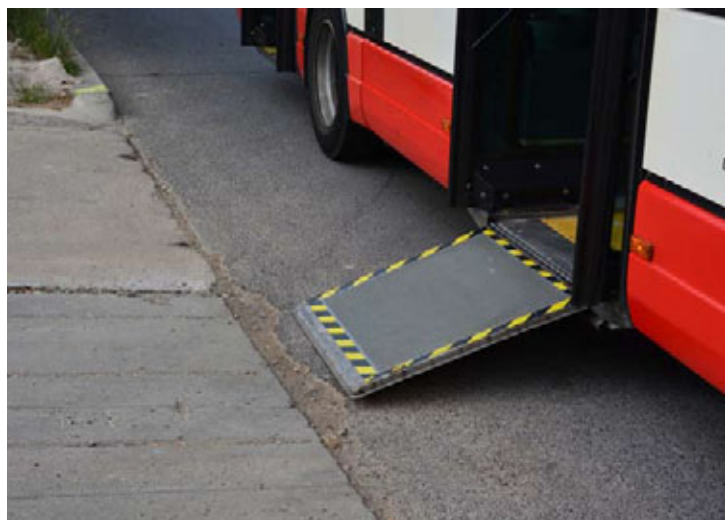
Velký úhel vyklonení plošiny v zastávce bez zvýšené nástupní hrany.
