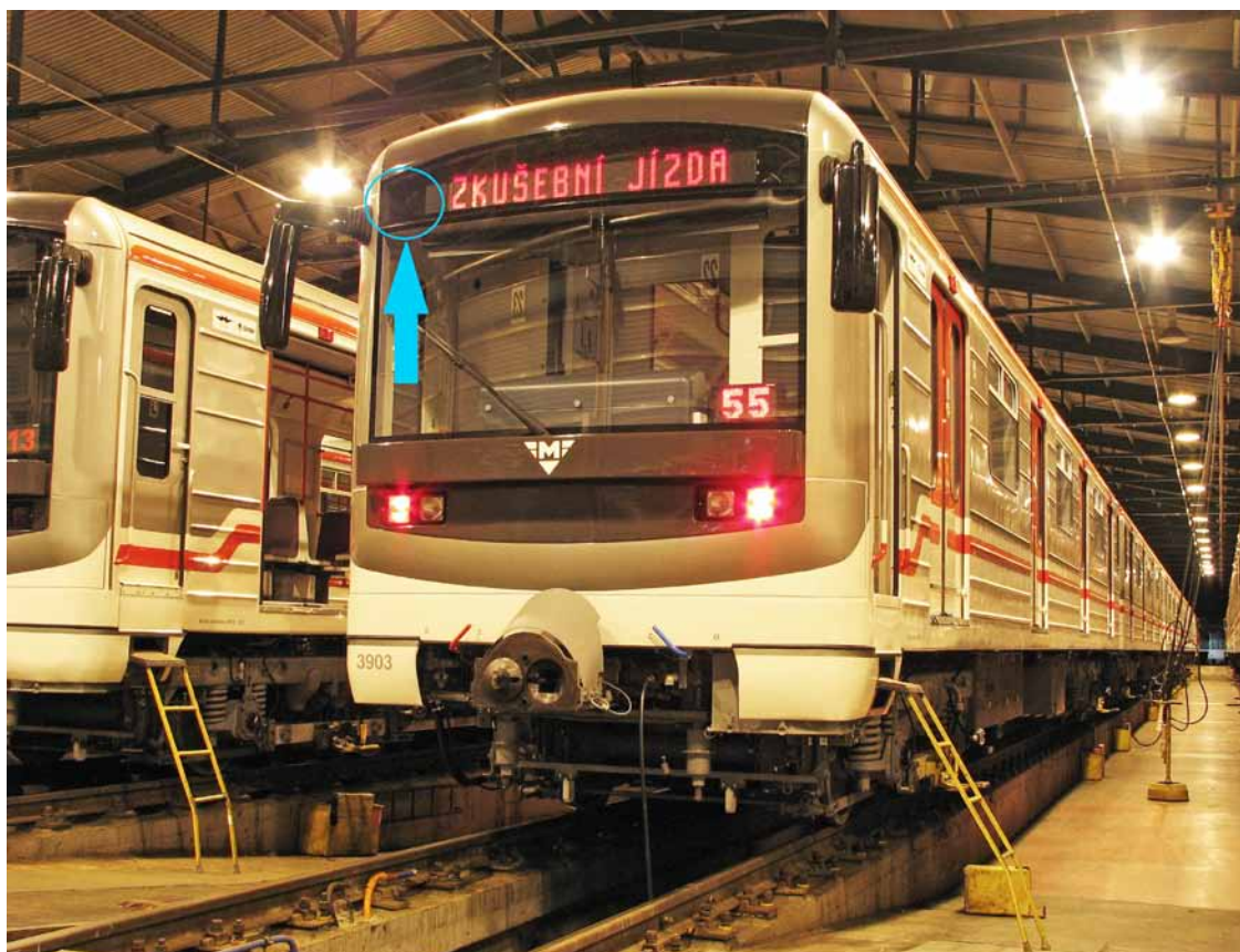
Anténa WiFi je umístěna na čele vlaku v prostoru čelního informačního panelu (označeno modrou šipkou).
