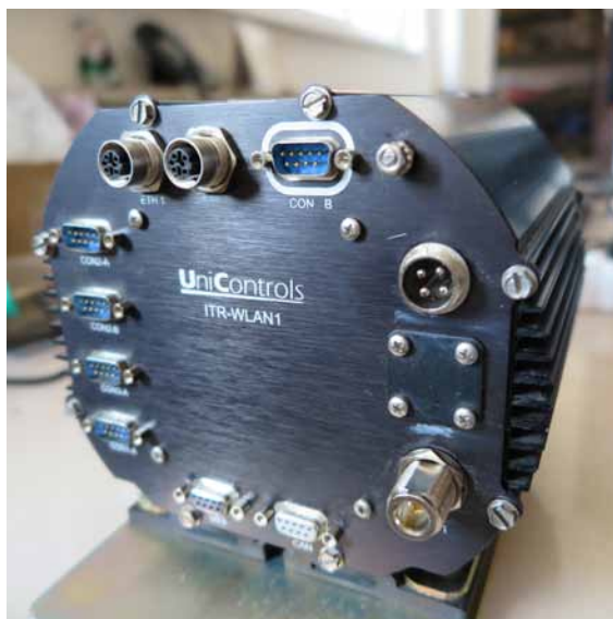
Komunikační jednotka ITR-WLAN je počítač v průmyslovém provedení s řadou připojovacích konektorů.
