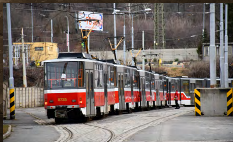
PŘED ZAHÁJENÍM SUNUTÍ DOŠLO KE SPOJENÍ VOZŮ NA Odstavných a OBJÍZDNÝCH KOLEJÍCH
