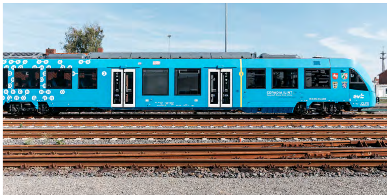
VLAČOVÁ SOUPRAVA NA VODÍK ALSTOM CORADIA ILINT V DOLNÍM SASKU ZDROJ: ALSTOM
