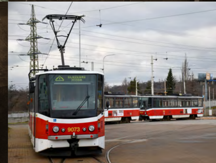
K SUNUTÍ VOZŮ BYLA VYUŽITA TRAMVAJ KT8D5R.N2P, A TO ZEJMÉNA KVŮLI SVÉ DÉLCE, OBOUSMĚRNOSTI, SÍLE TRAKČNÍCH MOTORŮ A ZEJMÉNA MOŽNOSTI VYUŽITÍ VZDÁLENĚJŠÍHO PANTOGRAFU
