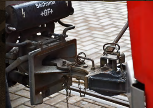
JISTOU KOMPLIKACI PŘEDSTAVOVALY DVA TYPY SPŘÁHEL – SÉCHERON A TZV. PRAŽSKÁ HLAVA
