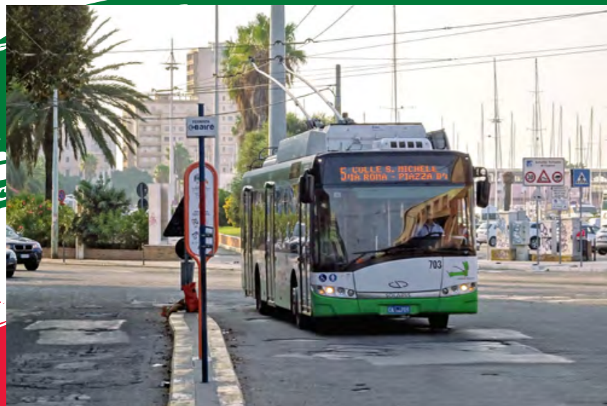
SOLARIS TROLLINO NA LINCĚ 5 POBLÍŽ NÁDRAŽÍ V CAGLIARI. ZA POVŠIMNUTÍ STOJÍ VSKUTKU „ŠIROKÝ“ NÁSTUPNÍ OSTRŮVEK. VLEVO OD NĚJ JSOU POD VRSTVOU ASFALTU PATRNĚ ZBYTKY KOLEJÍ Z PŮVODNÍHO TRAMVAJOVÉHO PROVOZU
