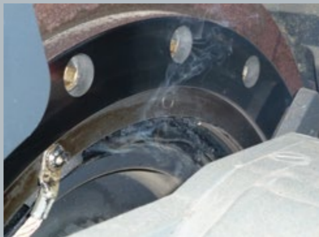
VYTÉKAJÍCÍ PRYŽ ZE ZA TEPLA PROTOČENÉHO KOLA 15T
