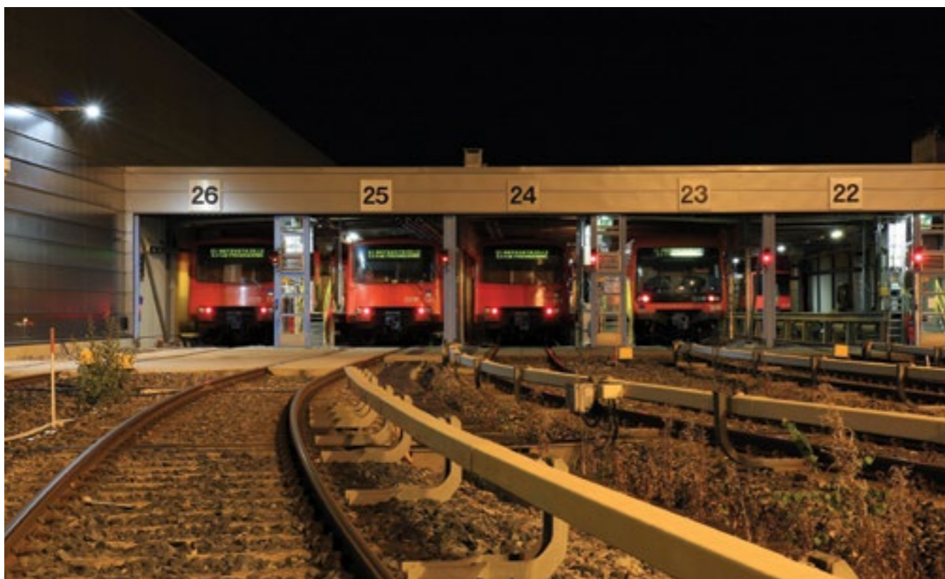
SNÍMEK BYL POŘÍZEN V NOCI ZE 14. NA 15. ZÁŘÍ 2016 V DEPU HELSINKY. BRÁNY DEPA JSOU TRVALE ZAVŘENÉ VE DNE I V NOCI A AUTOMATICKY SE OTEVÍRAJÍ JEN PRO URČITOU KOLEJ, KDYŽ SE BLÍŽÍ SOUPRAVA METRA. SOUPRAVY METRA TYPU M100 (PRVNÍ TŘI SOUPRAVY VLEVO) A SOUPRAVA METRA TYPU M200 (ČTVRTÁ ZLEVA: M205-M206) SE NACHÁZEJÍ V DEPU BĚHEM NOČNÍHO STÁNÍ
