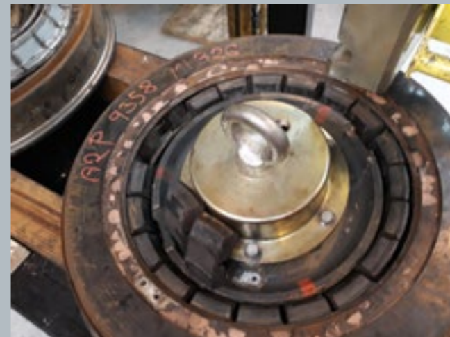
CELÉ KOLO A JEHO DETAIL PO VYJMUTÍ PŘÍTLAČNÉHO KROUŽKU, KDY JE VIDĚT POZICE SEGMENTŮ V KOLE
