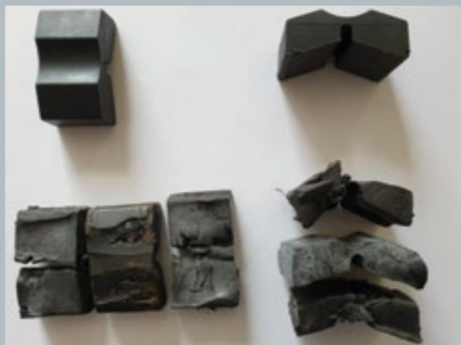
RŮZNÁ POŠKOZENÍ A DEFORMITY POUŽITÝCH PRYŽOVÝCH SEGMENTŮ. NAHOŘE JSOU SEGMENTY NOVÉ
