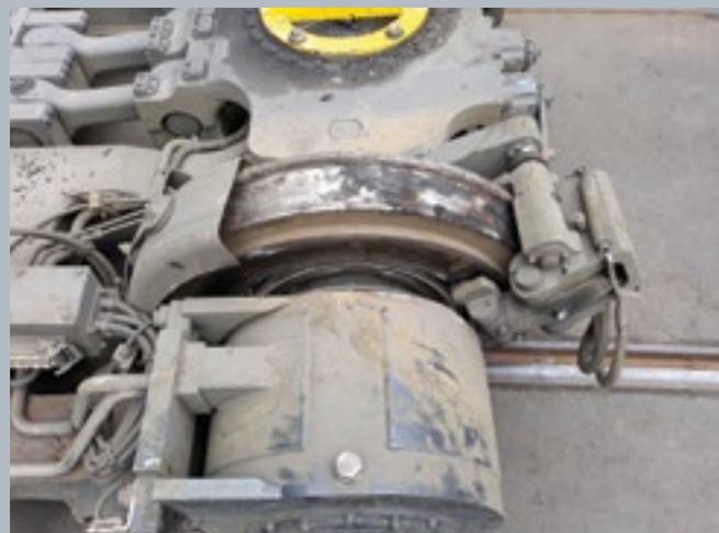
PODVOZEK VOZU 15T – DETAIL OBRUČE KOLA PO VYKOJENÍ. ZDE JE PATRNÉ, ŽE NEJÍŽDĚNÍ OBRUČ ZTRATIT...
