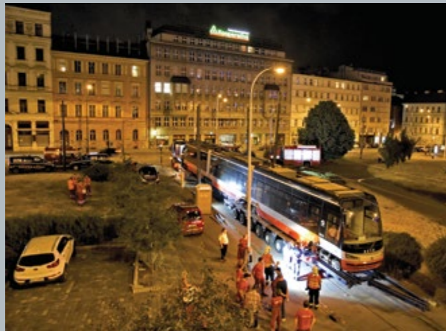
20. ČERVNA 2017. V TÉ DOBĚ NEBYLA MOŽNOST VŮZ „POSADIT“ NA HAVARIJNÍ PODVOZEK, JELIKOŽ NEEXISTOVAL. NEZBYVALO NIC JINÉHO, NEŽ VŮZ NALOŽIT NA PODVALNÍK A ODVÉZT K OPRAVĚ
