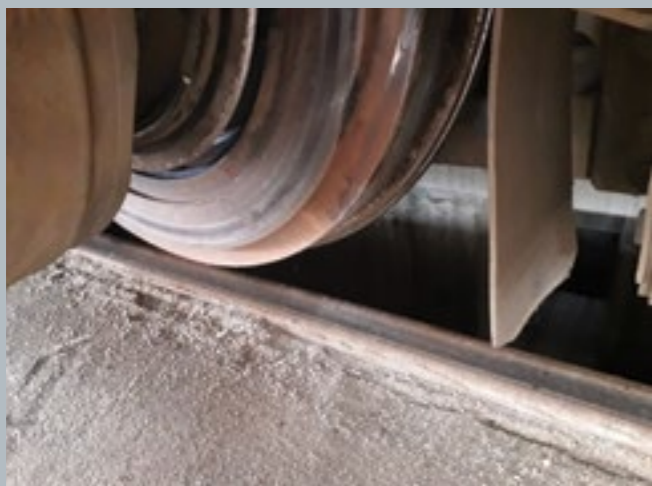
DETAIL UVOLNĚNÉ OBRUČE KOLA 15T
