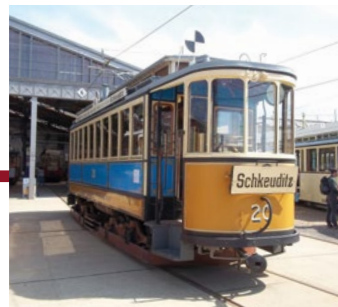
ČTYRNÁPRAVOVÝ MOTOROVÝ VŮZ ČÍSLO 20 BYL VYROBEN V ROCE 1910 VAGONKOU V BRÉMÁCH. BYL URČEN PRO MEZIMĚSTSKÉ TRAMVAJOVÉ LINKY DO SCHKEUDITZ, MARKKLEEBERGU, TAUCHY, A LOKALITY BÖHLITZ – EHRENBERG. VYBAVEN BYL PODOVKY MAXIMUM TRAKTION (VŮZ MĚL POHÁNĚNOU PRVNÍ A ČTVRTOU NÁPRAVU) A VZDUCHOVOU BRZDOU. V ZIMNÍM OBDOBÍ SE DOSAZOVALA DO VOZU KAMNA. K POVINNOSTEM PRŮVODČÍHO PATŘILO I UDRŽOVÁNÍ TEPELNÉ POHODY CESTUJÍCÍCH. OD ROKU 1928 BYLO TOPENÍ KAMNY NAHAZENO TOPENÍM ELEKTRICKÝM. VOZY TOHOTO TYPU PROŠLY RŮZNÝMI MODERNIZACEMI A JEZDILY CCA DO ROKU 1970. VŮZ Č. 20 BYL V LETECH 1977–1988 RESTAUROVÁN NA HISTORICKÝ
