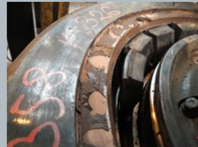
CELÉ KOLO A JEHO DETAIL PO VYJMUTÍ PŘÍTLAČNÉHO KROUŽKU, KDY JE VIDĚT POZICE SEGMENTŮ V KOLE
