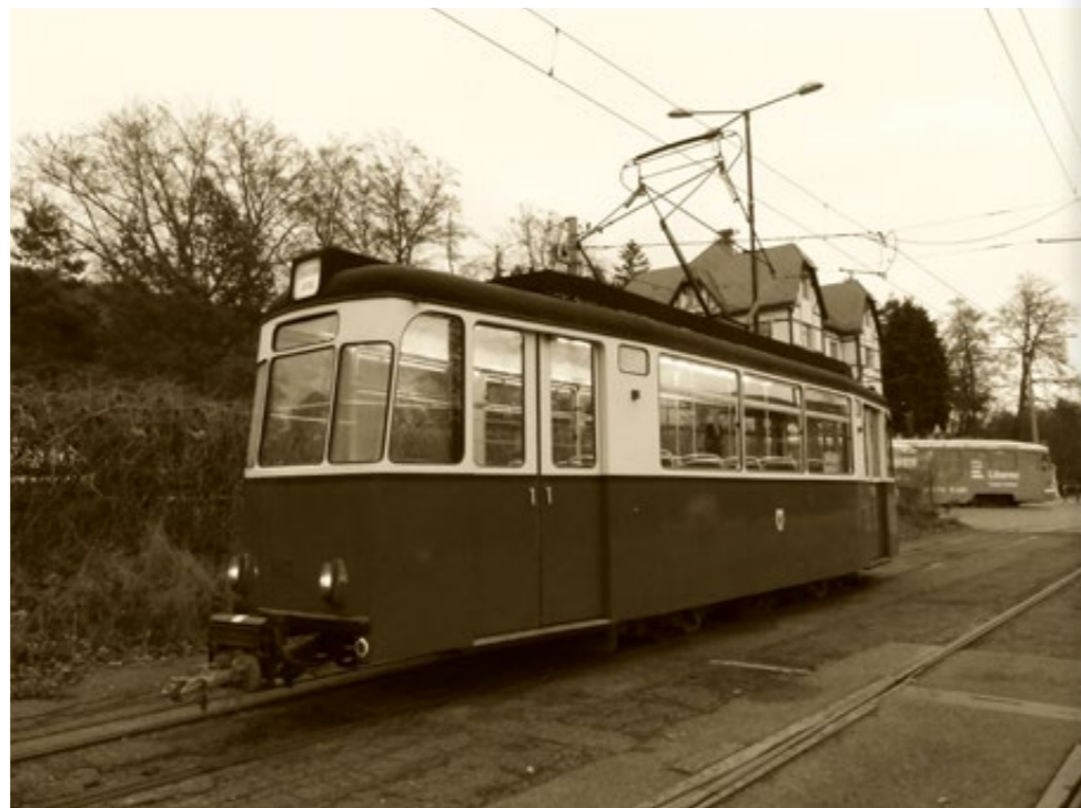
NA SNÍMKU Z LIDOVÝCH SADŮ ZAUJME AUTOMATICKÉ SPŘÁHLO S NASAZENOU REDUKCÍ NA PRAŽSKÝ TYP
