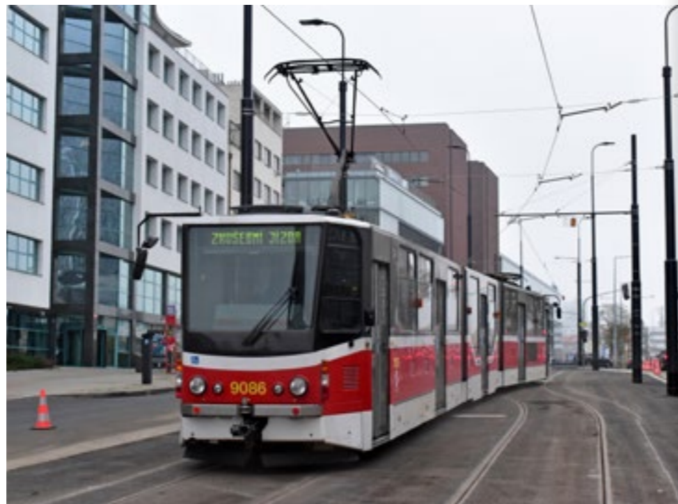
OBOUSMĚRNÉ VOZY ŘADY KT8 BUDOU DÁLE V HLEDÁČKU DPP – SE STŘEDNÍM NÍZKOPODLAŽNÍM CLÁNEM BUDOU VYUŽÍVÁNY NA ÚVRAŤOVÝCH OBRÁTÍŠTÍCH
