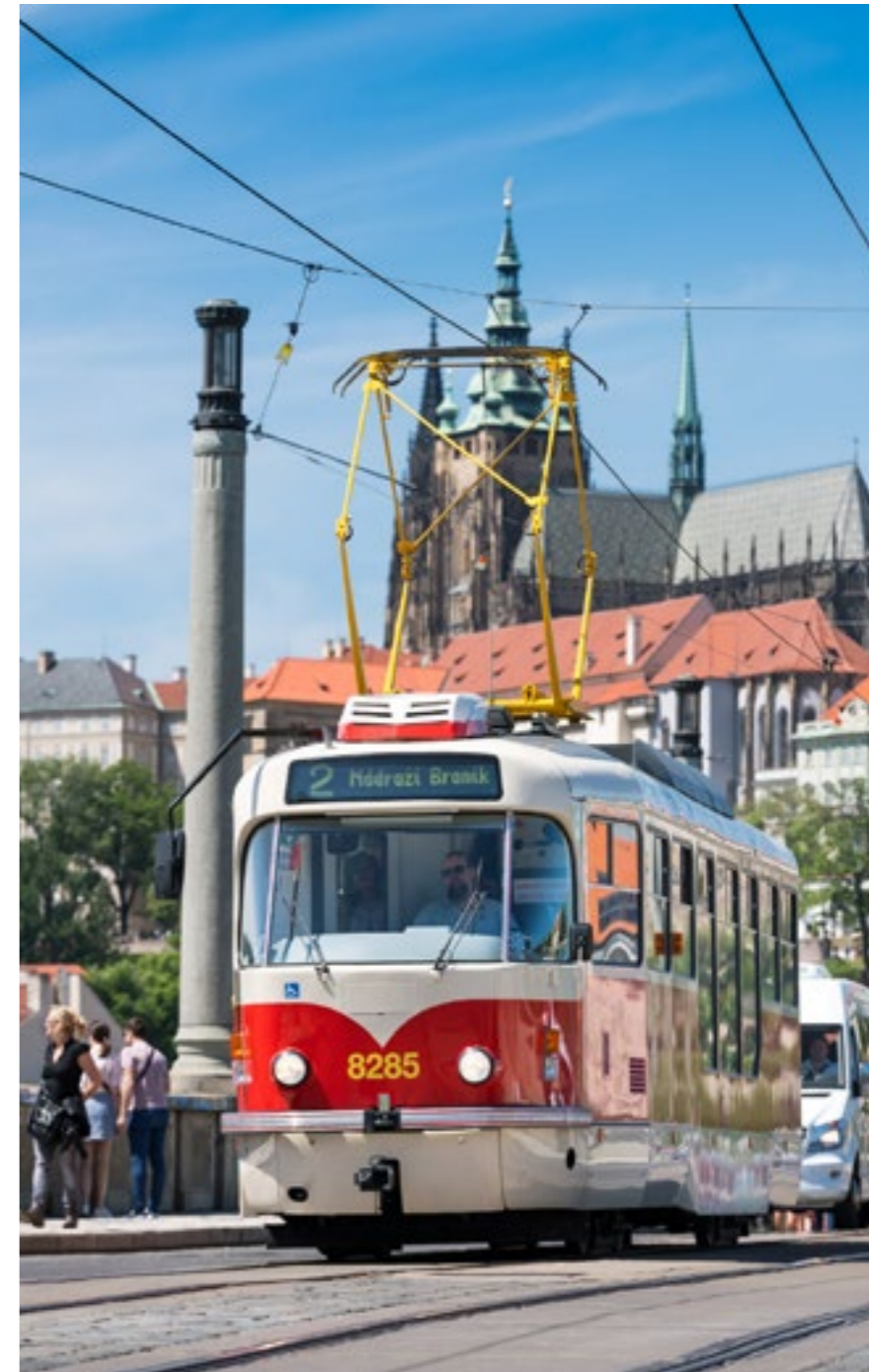
PILOTNÍ REKONSTRUKCE VOZU T3R.PV DO PODOBY TZV. NOVÉ WANY. DALŠÍ POTŘEBA SÓLO VOZŮ BUDE NAPLŇOVÁNA REKONSTRUKCEMI VOZŮ T3R.P
