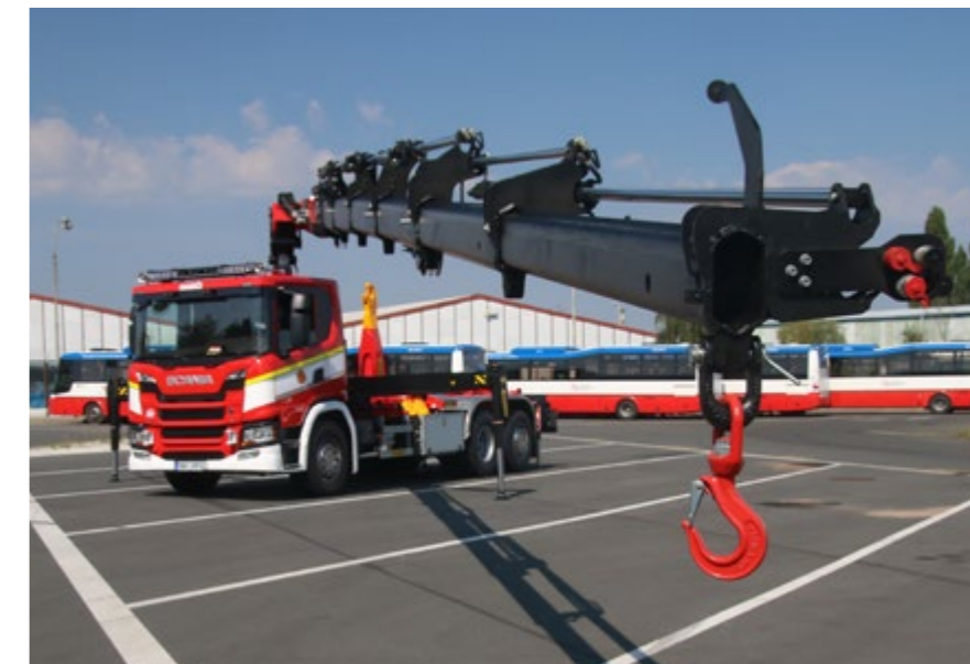
MAXIMÁLNÍ DOSAH HYDRAULICKÉHO NAKLÁDACÍHO JEŘÁBU JE 19 METRŮ
