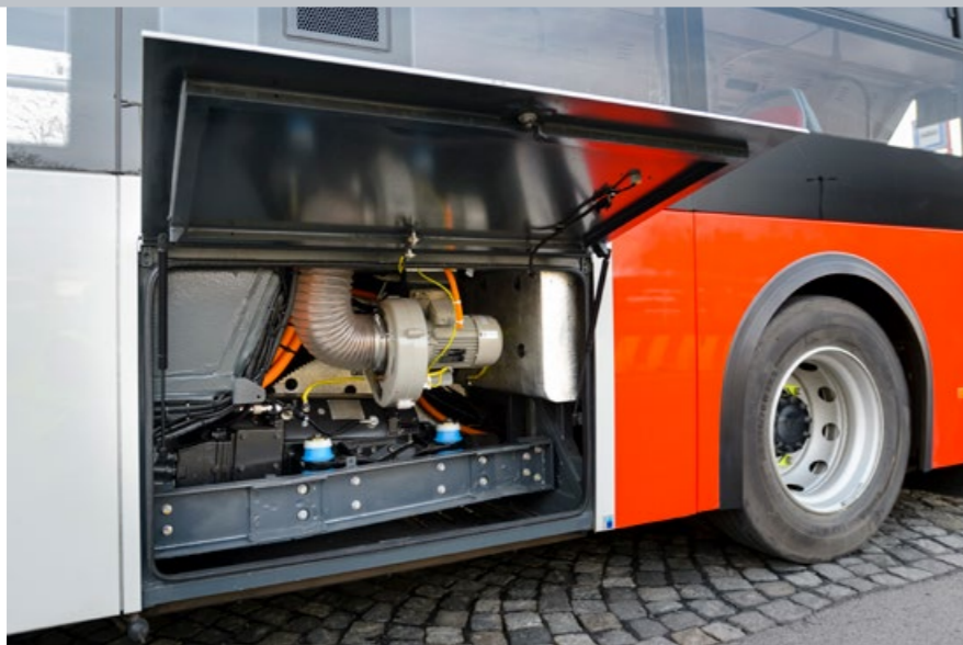
ELEKTROBUS JE POHÁNĚN JEDNÍM TROJFÁZOVÝM ČTYŘPÓLOVÝM ASYNCHRONNÍM MOTOREM S KOTVOU NAKRÁTKO ŠKODA 8 ML 3444 K/4 (ČERNÉ BARVY DOLE V RÁMU) A CIZÍ VENTILACÍ (ŠEDIVÁ V HORNÍ ČÁSTI). V BOČNÍCH A ZADNÍ ŠCHRÁNĚ ELEKTROBUSU MNOHO DALŠÍCH KOMPONENTŮ NENÍ. VĚTŠINA ELEKTRICKÉ VÝZBROJE VČETNĚ BATERIÍ JE UMÍSTĚNA NA STŘEŠE
