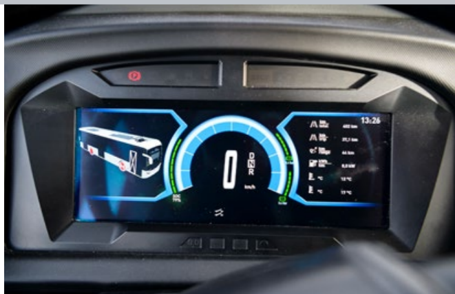
O STAVU VOZIDLA INFORMUJE ŘIDIČE MULTIFUNKČNÍ BAREVNÝ DISPLEJ. NA DISPLEJI SE ROVNĚŽ ZOBRAZUJE OBRAZ Z COUVACÍ KAMERY NEBO Z KAMERY SLEDUJÍCÍ PANTOGRAF
