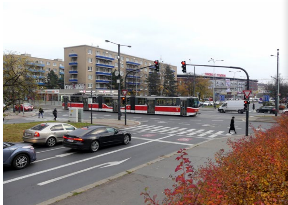
ZAVEDENÍ PREFERENCE TRAMVAJÍ I AUTOBUSŮ SE PO LETECH DOČKAL SEMAFOR U SLAVIE SIGNALIZACE NAVÍC FUNGUJE V DYNAMICKÉ KOORDINACI SE DVĚMA SOUSEDNÍMI SIGNALIZACEMI, COŽ ŠETŘÍ ČAS A ZASTAVOVÁNÍ NEJEN MHD, ALE I AUTŮM
