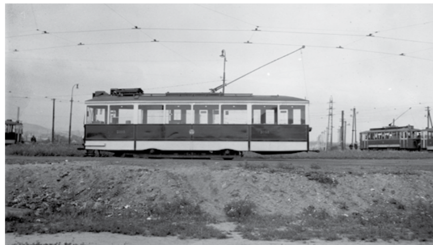
POSLEDNÍ DODANÝ VŮZ TYPU „MEVRO“ Č. 3098 BYL SVĚDKEM MNOHA ZKOUŠEK NOVÝCH KOMPONENTŮ PRO VÝVOJ ČTYŘNÁPRAVOVÉ TRAMVAJE PCC. NA SNÍMKU JE ZACHYČEN VE SMYČCE NOVÉ PRODLOUŽENÉ TRATĚ DO NOVÉHO HLOUBĚTINA V ROCE 1949 PŘI ZKOUŠKÁCH SBĚRAČE TROLEJBUSOVÉHO TYPU, SYSTÉMU OHIO BRASS, KTERÝ BYL POZDĚJI POUŽIT PRO TRAMVAJE T1
