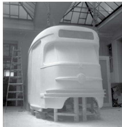
VELKÁ PÉČE BYLA VĚNOVÁNA TVAROVÉMU ŘEŠENÍ NOVÉ TRAMVAJE T II. VARIANTNÍ ŘEŠENÍ BYLA KROMĚ KRESEBNÝCH NÁVRHŮ OVĚŘOVÁNA I NA MAKETĚ VE SKUTEČNĚ VELIKOSTI. ZPRACOVÁNÍ NÁVRHŮ SE OPĚT PROFESIONÁLNĚ ZHOSTIL VÝTVARNÍK FRANTIŠEK KARDAUS
