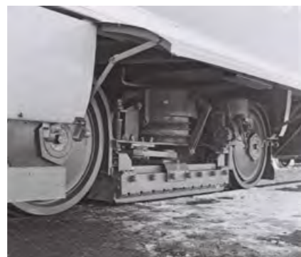
DETAIL ZAVÁZANÉHO PODVOZKU PCC PRO ROZCHOD 1435 MM PRO TRAMVAJ TYPU T II Z ROKU 1957. MEZI ODPRUŽENÝMI KOLY JE VIDĚT ČÁST KOLÉBKY A JEJÍHO VYPRUŽENÍ, BRZDIČ MECHANICKÉ BRZDY A KOLEJNICOVÁ BRZDA
