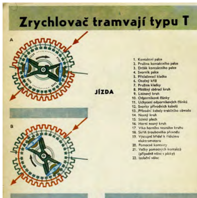
ZRYCHLOVAČ TRAMVAJE ŘADY T V NÁZORNÉM ŘEZU NA DOBOVÉ ILUSTRACI Z UČEBNICE ŘIDIČE TRAMVAJE A TROLEJBUSU VYDANÉ V ROCE 1969 (VPRAVO). V DETAILU ČINNOST ZRYCHLOVAČE PŘI ROZJEZDU – A PRŮBĚH PROUDU PŘI POČÁTKU ROZJEZDU Z KLIDU, B PRŮBĚH PROUDU VE STŘEDNÍ POLOZE FOTO: ARCHIV DPP
