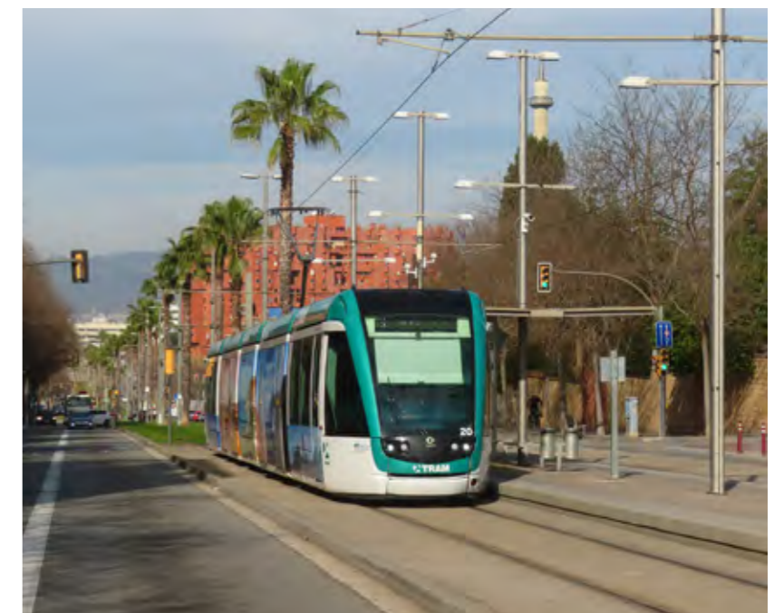
SNÍMEK Z DVOUKOLEJNÉ TRATI V OSE ULICE (SÍŤ TRAMBAIX)
