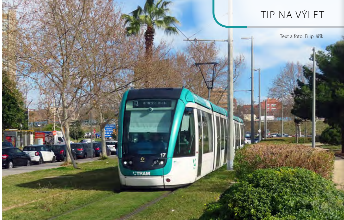
TRAMVAJ ALSTOM CITADIS 302 NA JEDNOKOLEJNÉ TRATI V SÍTI TRAMBAIX
