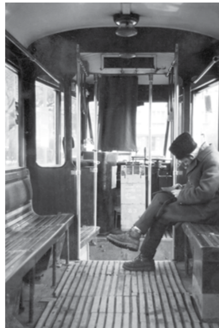
DVA POHLEDY DO INTERIÉRU JEDNOSMĚRNÉHO MOTOROVÉHO VOZU Č. 3062 V POSLEDNÍCH DNECH PROVOZU (8. 12. 1967). V PŘEDNÍ ČÁSTI VOZU ZAUJMOU DODATEČNĚ DOPLNĚVANÉ PŘEPÁŽKY, JIMIŽ BYLA VYZTUŽENA VOZOVÁ SKŘÍŇ, A POKLADNA SAMOOBSLUŽNÉHO PROVOZU. V ZADNÍ ČÁSTI POD SEDADLEM JE UMÍSTĚNA BATERIE PRO DODATEČNĚ INSTALOVANÉ PRVKY 24 V
