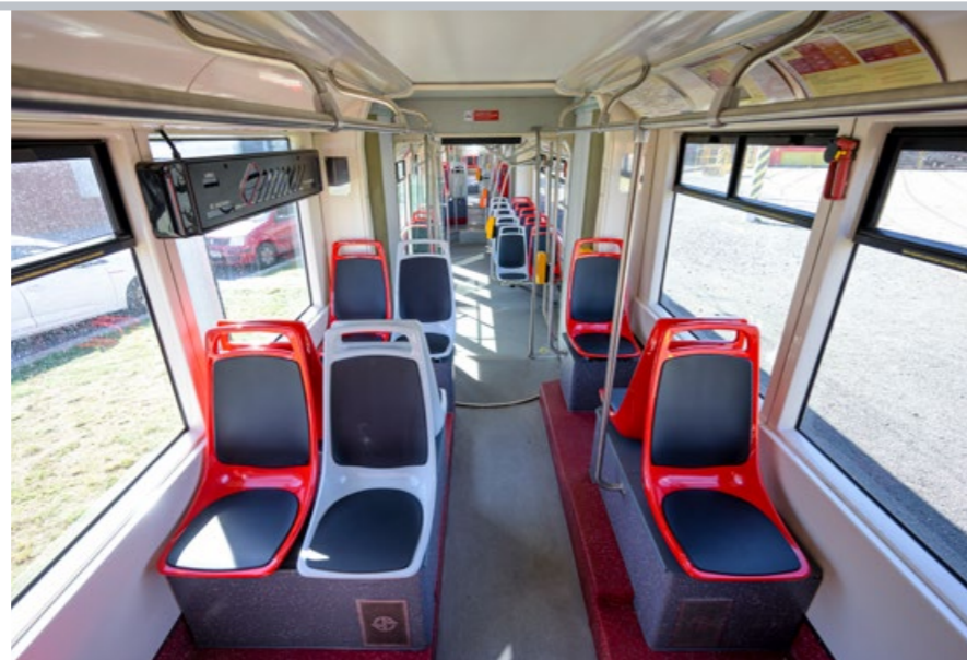
ZMĚNY V INTERIÉRU JSOU VIDĚT NA PRVNÍ POHLED. KROMĚ ZMĚN SEDAČEK A JEJICH USPOŘÁDÁNÍ DOŠLO I K ÚPRAVĚM ZÁDRŽENÉHO SYSTÉMU
