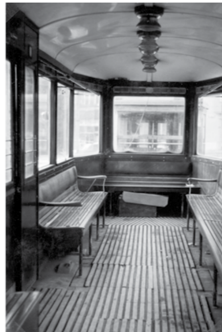
DVA POHLEDY DO INTERIÉRU JEDNOSMĚRNÉHO MOTOROVÉHO VOZU Č. 3062 V POSLEDNÍCH DNECH PROVOZU (8. 12. 1967). V PŘEDNÍ ČÁSTI VOZU ZAUJMOU DODATEČNĚ DOPLNĚVANÉ PŘEPÁŽKY, JIMIŽ BYLA VYZTUŽENA VOZOVÁ SKŘÍŇ, A POKLADNA SAMOOBSLUŽNÉHO PROVOZU. V ZADNÍ ČÁSTI POD SEDADLEM JE UMÍSTĚNA BATERIE PRO DODATEČNĚ INSTALOVANÉ PRVKY 24 V
