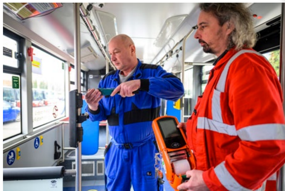
V RÁMCI STANDARDNÍ PŘÍPRAVY VOZIDEL NA PROVOZ BYL BATERIOVÝ TROLEJBUS VYBAVEN I BEZKONTAKTNÍM PLATEBNÍM TERMINÁLEM PRO NÁKUP JÍZDENEK
