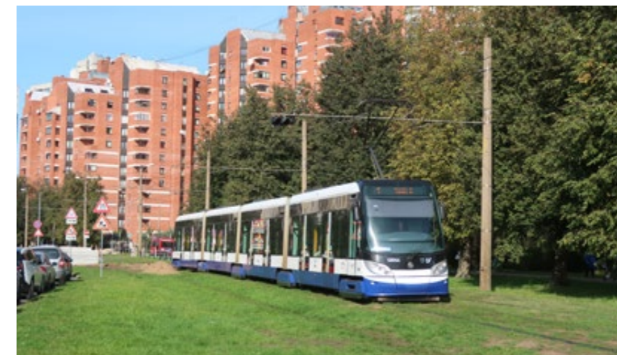
NAJDETE ROZDÍL OPROTI PRAŽSKÝM VOZŮM 15T? JE TO NEJEN ODLIŠNÉ BAREVNÉ SCHÉMA, ALE PŘEDEVŠÍM ČTYŘČLÁNKOVÉ PŘÍKONOVÉ VOZOVÉ SKŘÍNĚ. TO DODÁVÁ TĚMTO VOZŮM NEJEN ÚČTYHODNOU DÉLKU, ALE I POTŘEBNOU KAPACITU. TO SE NA PÁTEŘNÍ LINCĚ 1, KTERÁ OBSLUHUJE I VELKÉ SÍDLIŠTĚ IMANTA, JISTĚ HODÍ
