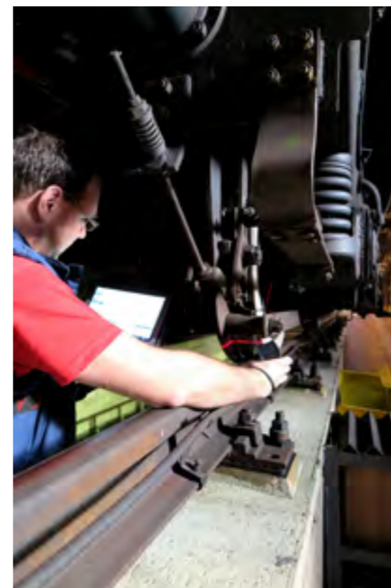
HISTORICKOU SOUPRAVU EČS BYSTE ASI Z TOHOTO SNÍMKU NEPOZNALI. TAKTO NA NÍ PROBÍHÁ MĚŘENÍ OPOTŘEBENÍ JÍZDNÍHO PROFILU KOLA LASEROVÝM PŘÍSTROJEM CALIPRI
