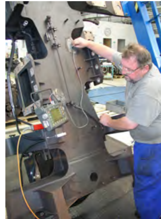
PRACOVNÍK TECHNICKÉ KONTROLY JSVM NA RÁMU PODVOZKU M1 KONTROLUJE POMOCÍ ULTRAZVUKOVÉ DEFEKTOSKOPIE KRITICKÉ MÍSTO. TOUTO NEDESTRUKTIVNÍ METODOU JE MOŽNO ZJISTIT PODPOVRCHOVÉ VADY V MATERIÁLU A VYUŽÍVÁ SE JAK PRO HLEDÁNÍ VAD V POČATEČNÉM STADIU VÝVOJE, TAK PRO KONTROLU PO PROVEDENÉ OPRAVĚ SVAŘOVÁNÍM
