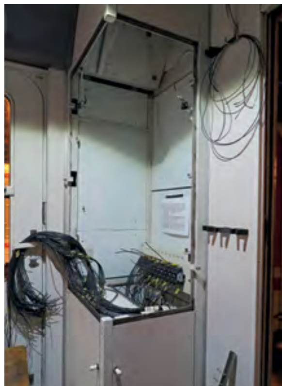
PŘEPOJENÍ KABELÁŽE NOVÉHO VLAKOVÉHO ZABEZPEČOVAČE LZA NA OBOU ČELECH VOZŮ 3191 A 3194
