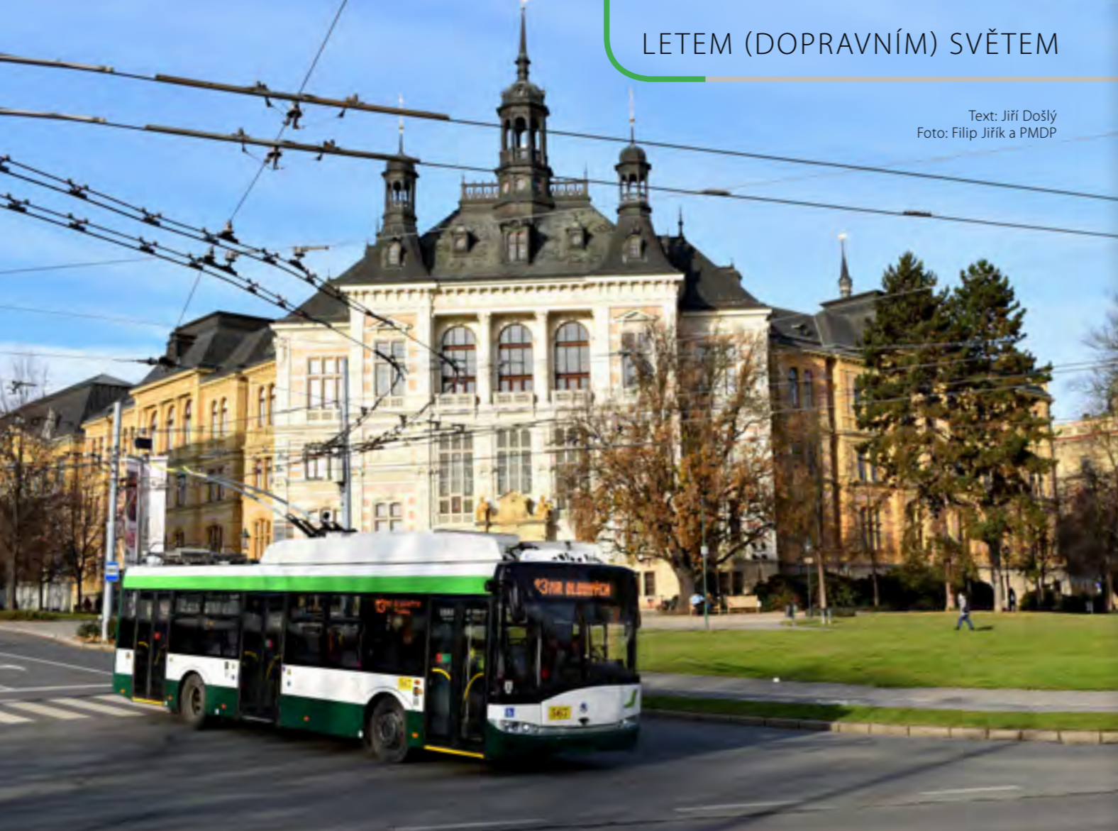
ŠKODA 26TR SOLARIS PATŘÍ V PLZNI K NEJNOVĚJŠÍM, JE VYBAVEN I BATERIOVÝM POHONEM
