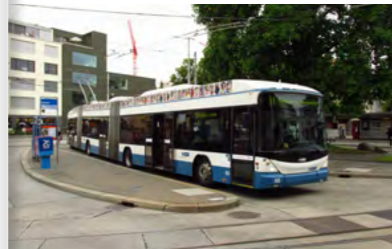
TŘÍČLÁNKOVÉ TROLEJBUSY HESS LIGHT TRAM O DÉLCE NECELÝCH 25 METRŮ JEZDÍ VE ČTYŘECH ŠVÝCARSKÝCH MĚSTECH. SNÍMEK POCHÁZÍ Z CURYCHU
