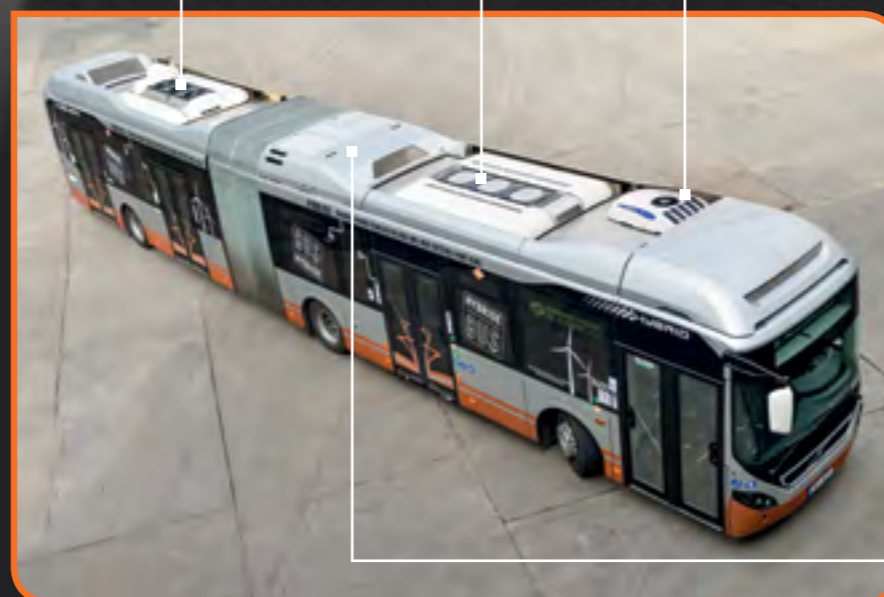
Klimatizační jednotky interiéru vozu a samostatná klimatizace pracoviště řidiče
