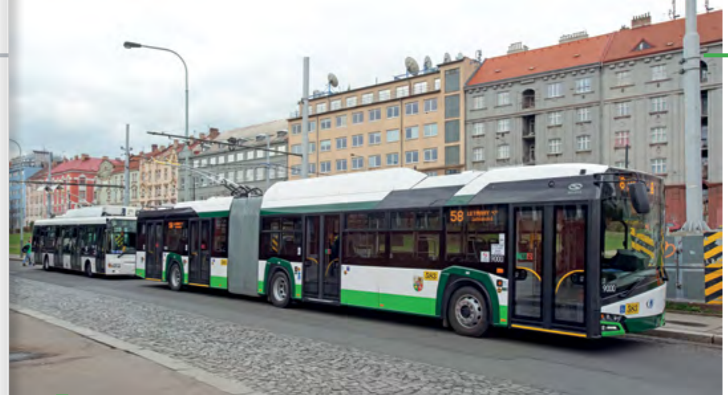
OBA AKTUÁLNĚ PROVOZOVANÉ BATERIOVÉ TROLEJBUSY VYUŽÍVAJÍ PROVOZNÍ PŘESTÁVKU NA PALMOVCE K NABÍTÍ AKUMULÁTORŮ
