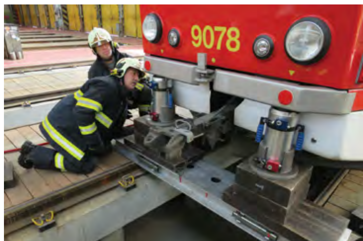
VÝJEZD S POŘADOVÝM ČÍSLEM 103, VOZOVNA KOBYLISY – TECHNICKÁ POMOC: PŘÍPRAVA NA ZVEDÁNÍ NEPOJÍZDNÉ TRAMVAJE KT8 PŘED NOUZOVOU OPRAVOU NÁKOLKU
