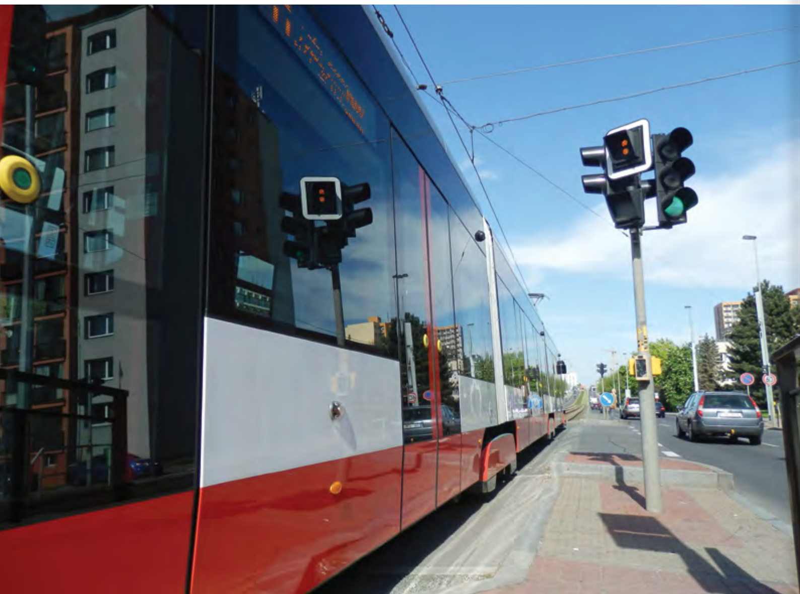
PREFERENCE TRAMVAJÍ BYLA V ROCE 2017 ZAVEDENA NA SSZ 6.160 EVROPSKÁ – GARÁŽE MV. TRAMVAJE SI ZDE MOHOU PRODLOUŽIT VLASTNÍ FÁZI, PŘEDVYBRAT KOLIZNÍ FÁZI A NAVÍC JEŠTĚ VLOŽIT FÁZI PŘED SIGNAL S LEVÝM ODBOČENÍM Z CENTRA. VÝHODNĚ SE PŘÍTOM VYUŽÍVÁ SYSTÉMOVÉ VLASTNOSTI DÉLENÝCH PŘECHODŮ PRO CHODCE PRO RŮZNÉ DÉLKY CHODECKÝCH ZELENÝCH
