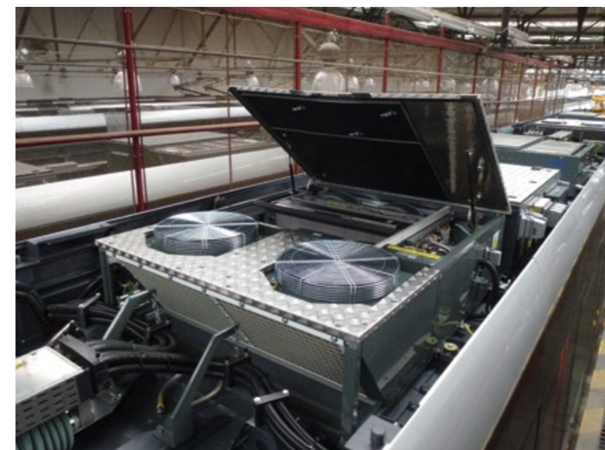
STŘECHA VOZU 15T JE PLNÁ TECHNOLOGIÍ A UMÍSTĚNÍ KLASICKÝCH STROPNÍCH NASÁVACÍCH KLAPEK NEPŘIPADÁ V ÚVAHU. NA FOTCE JE OTEVŘENÁ KLIMATIZAČNÍ JEDNOTKA VOZU 15T
