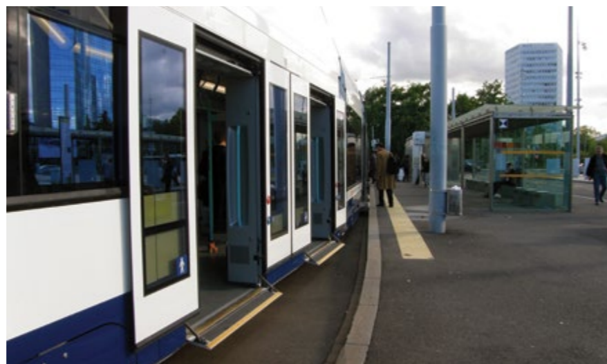
I V ŽENEVĚ PO ROZŠÍŘENÍ TRAMVAJOVÉHO SYSTÉMU VZROSTLA POPTÁVKA PO VEŘEJNÉ DOPRAVĚ NAD PŮVODNÍ ODHADY. ZASTÁVKA VE SMYČCE NATIONS (NOVOSTAVBA Z ROKU 2003) NEPOJME TRAMVAJ, VYROBENOU V ROCE 2011
