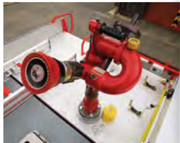
ODNÍMATELNÁ LAFETOVÁ PROUDNICE STINGER, TZV. VODNÍ DĚLO
