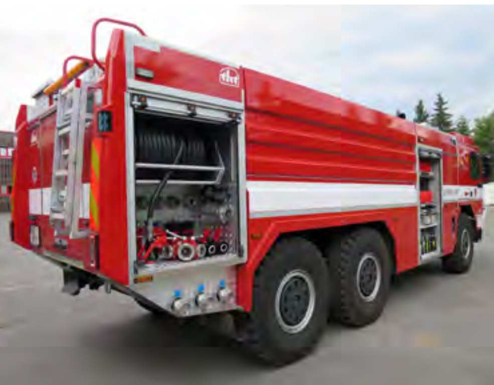
V PRAVÉ ZADNÍ SKŘÍŇI JE UMÍSTĚN NAVIJÁK VYSOKOTLAKÉHO HASIČÍHO ZAŘÍZENÍ
