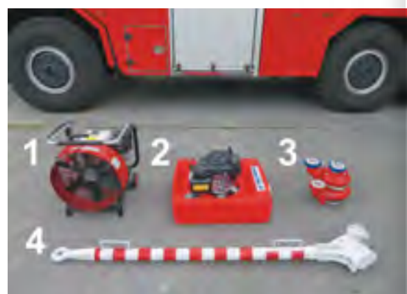
SPECIÁLNÍ PŘÍSLUŠENSTVÍ AUTOMOBILU: 1) PŘETLAKOVÝ VENTILÁTOR, 2) PLOVOUČÍ ČERPADLO, 3) TURBÍNOVÉ ČERPADLO, 4) VLEČNÁ TYČ PRO TRAMVAJE
