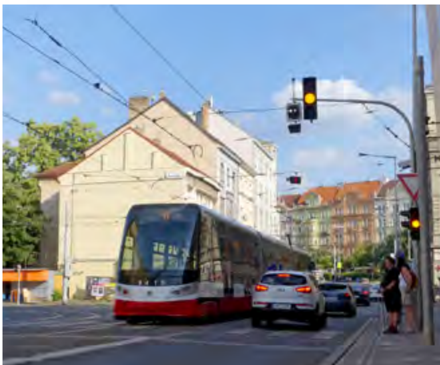
TRAMVAJ NA LINCĚ 11 VE SMĚRU Z CENTRA BEZ ZASTAVENÍ PROJÍZDÍ KŘÍŽOVATKOU. JAKMILE SE ODHLÁŠÍ, KONČÍ JEJÍ VOLNO A NÁSLEDNĚ KONČÍ TAKÉ ZELENÁ PRO AUTA
