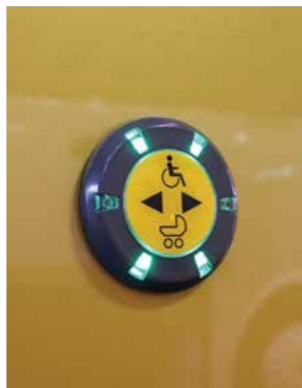
NOVÝ TYP TLAČÍTKA PRO POPTÁVKOVÉ OTEVŘÁNÍ DVEŘÍ
