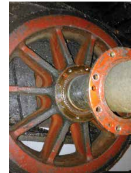
VADNÉ LOŽISKO KOLA NÁPRAVY VOZU LANOVKY
