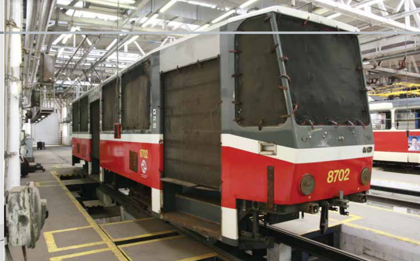
VŮZ Č. 8702 TAKTO ZASTIHL ROBERT MARA V ŘÍJNU 2014 V OPRAVNĚ TRAMVAJÍ PŘED OTRYSKÁNÍM SKŘÍNĚ
