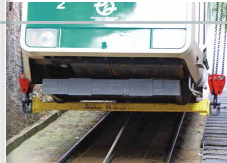
FÁZE DEMONTÁŽE NÁPRAVY Z VOZU ZAJIŠTĚNÉHO KLDKOSTROJEM S LANY A POPRUHY
