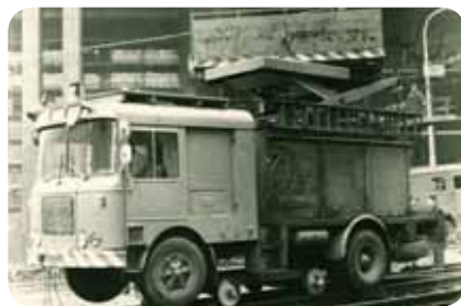
Montážní vůz s nástavbou a vybavením od firmy Schörling při práci s využitím pomocného podvozku na křižovatce u Muzea dne 5. prosince 1971. Ano, přesně tam, kde již dlouhá léta koleje nejsou, a snad za pár let zase budou.
