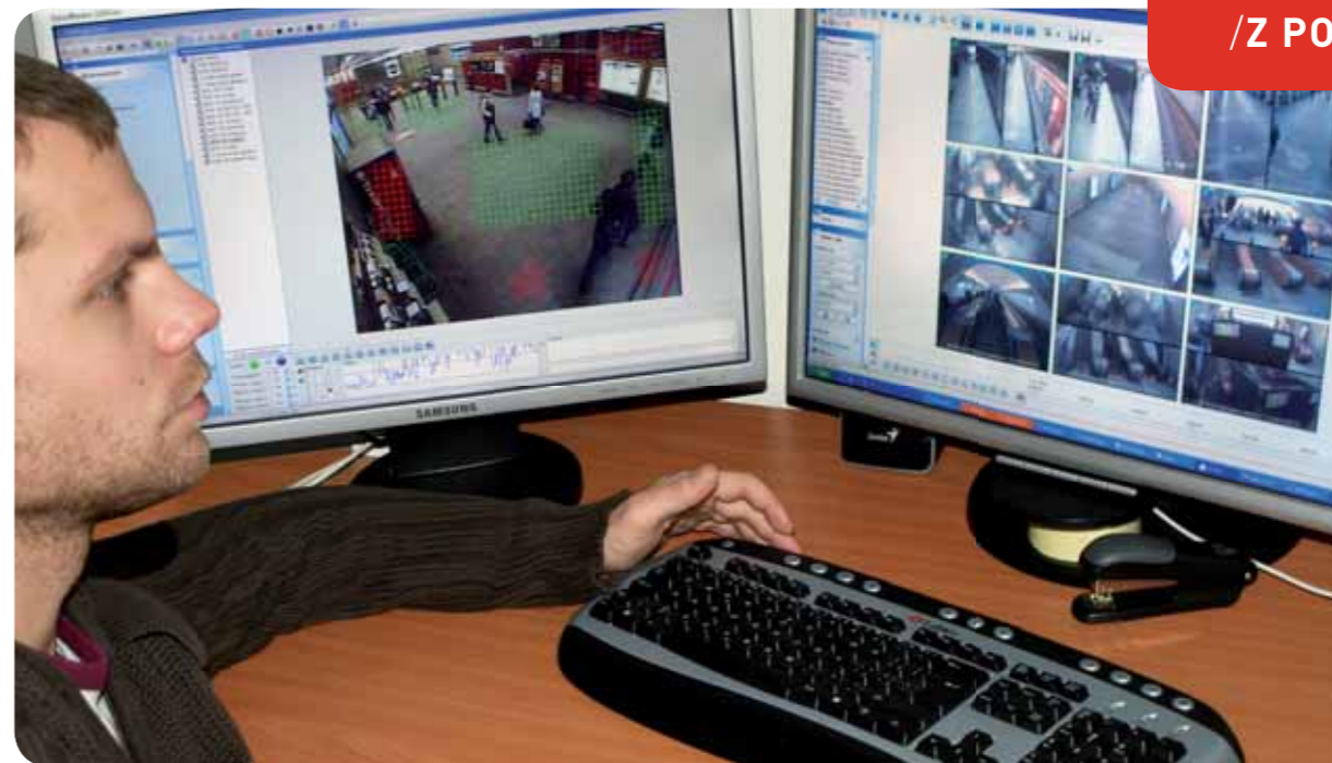
Servisní dohledové pracoviště. Konfigurace AD detekce (nastavování zón pohybové aktivity) v programu GeViScope (monitor vlevo) a uživatelské rozhraní grafického prohlížeče GSCView (monitor vpravo)
