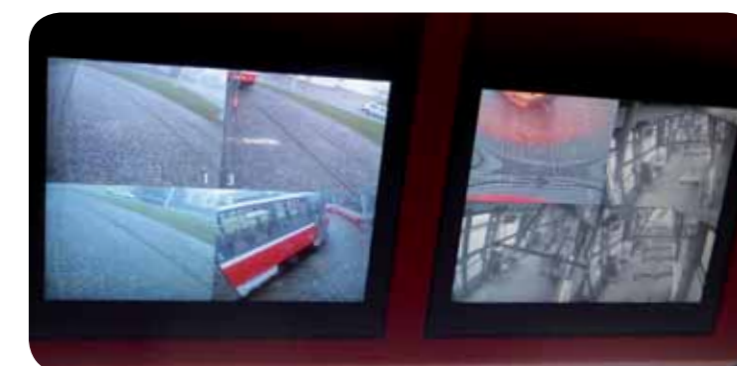
Řidič tramvaje 15T má k dispozici obraz z 8 kamer
