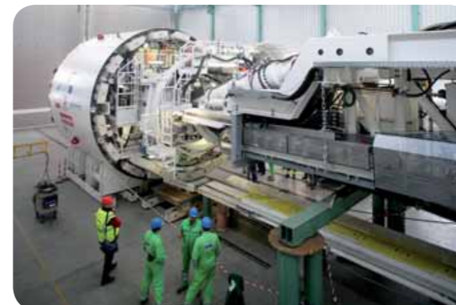
Technologický závěs složený ze sedmi 8 až 10 metrů dlouhých sekcí
