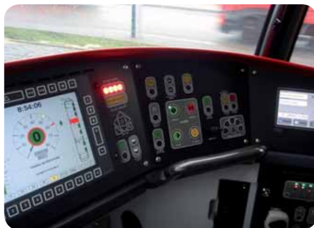
Displej zobrazuje mj. aktuální stav odpojení pohonu podvozků (červené pole)
