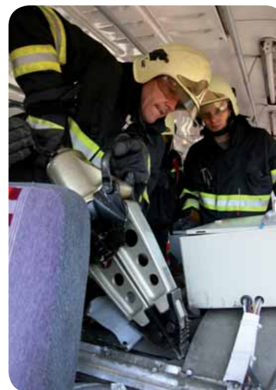
Zvedání tramvaje hydraulickým rozpínacím válcem.
