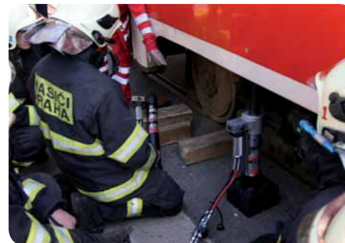
Zvedání tramvaje hydraulickým rozpínacím válcem.
