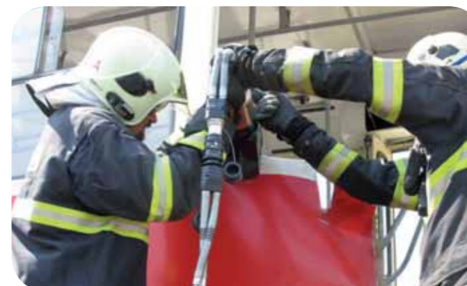
Dělení boku karosérie hydraulickým řezačem.
