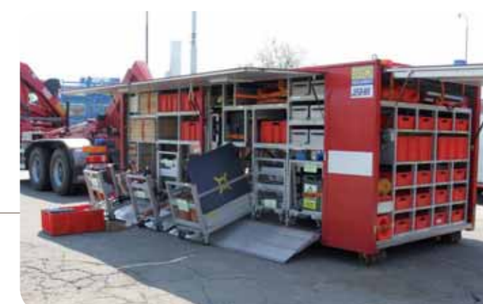
Technický kontejner s nosičem Mercedes Actros 6x6 HZS hl. m. Prahy.
