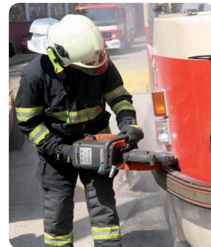
Oddělení laminátového čela rozbrušovací pilou.
