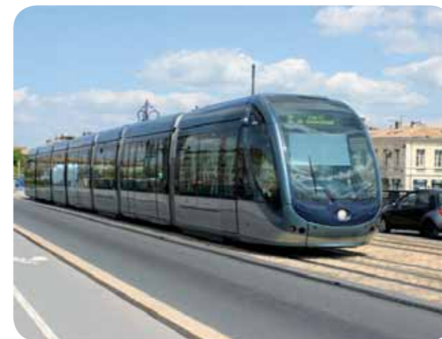
Souprava Citadis 402 na úseku s APS (Alimentation par sol = napájení ze země)
