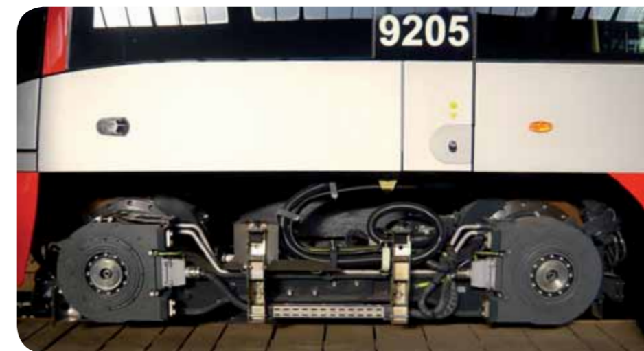
Plně trakční podvozek u dnes provozovaných tramvajů 15T ForCity
