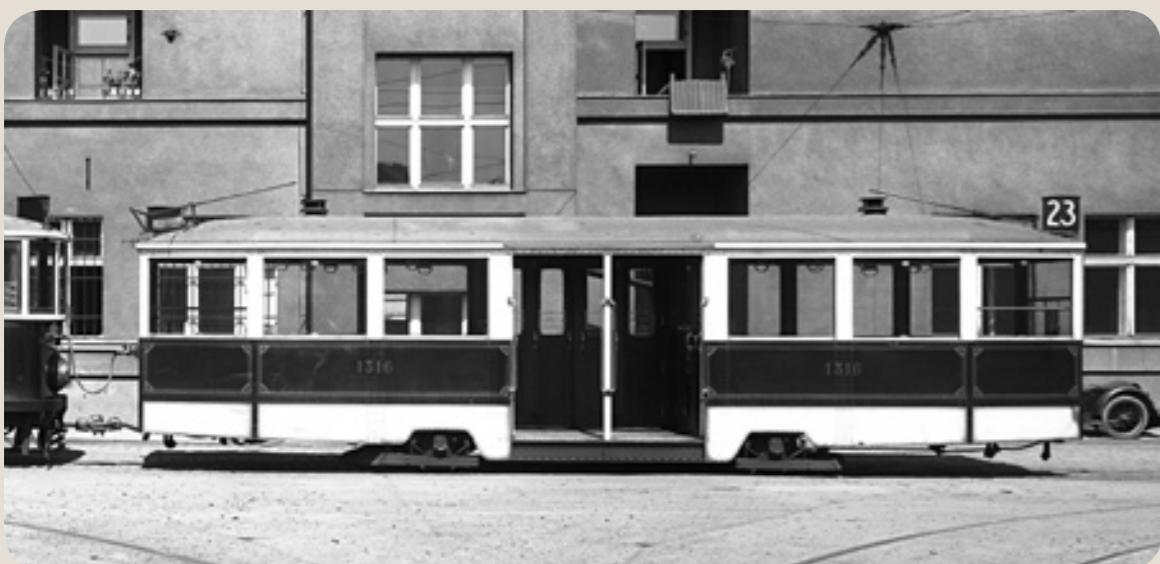
První pražská nízkopodlažní tramvaj – legendární „krasin“, jinak vlečný vůz se středním vstupem
