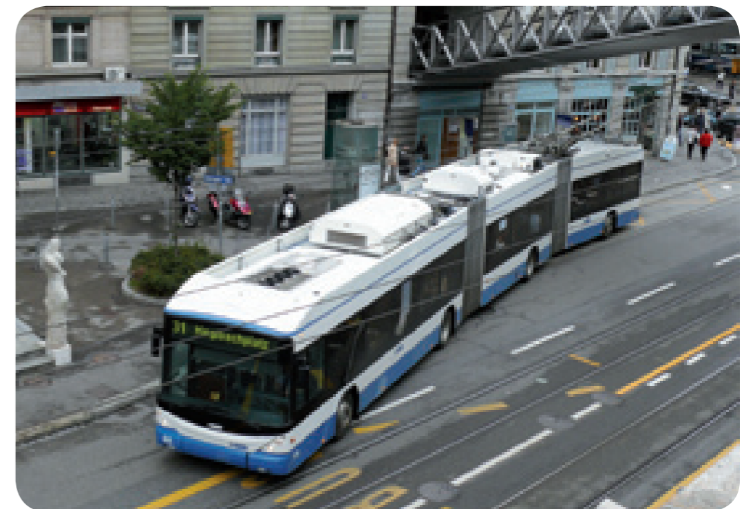
Tříčlankový trolejbus Hess (délka 24,7 m) na páteřní lince 31. Zürich, Švýcarsko
