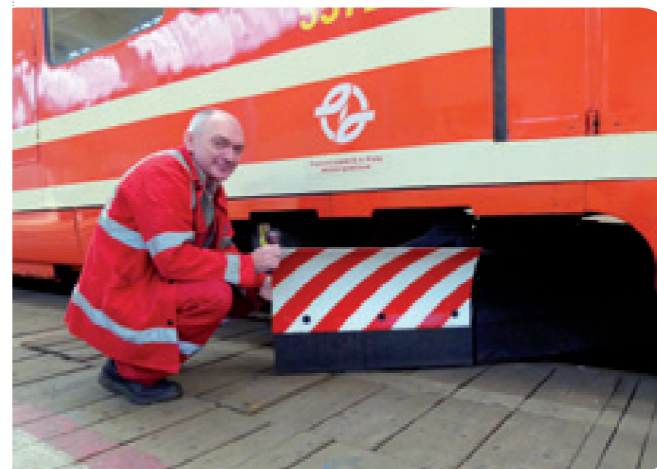
Mistr Josef Girgel z vozovny Pankrác ukazuje radlici, která umí nově pluzit i profil nízkopodlažních tramvajů
