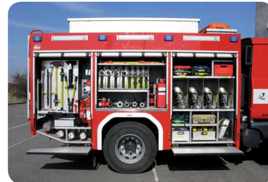
Pravok nástavby – zde mají svá přesně určená místa dýchací přístroje, zdravotnický materiál, hadice, armatury a ženíjný nářadí
