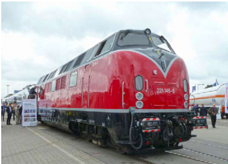
Vlevo: Remotorizovaná dieselhydraulická lokomotiva řady 221 DB má přes svůj věk (rok výroby 1953-58) stále místo na kolejích DB i dalších dopravců.
