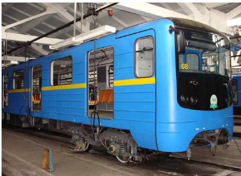
Vlevo: Rekonstruovaný vlak metra typu E, s revitalizovaným interiérem, dosazeným novým čelem a novou výzbrojí.
