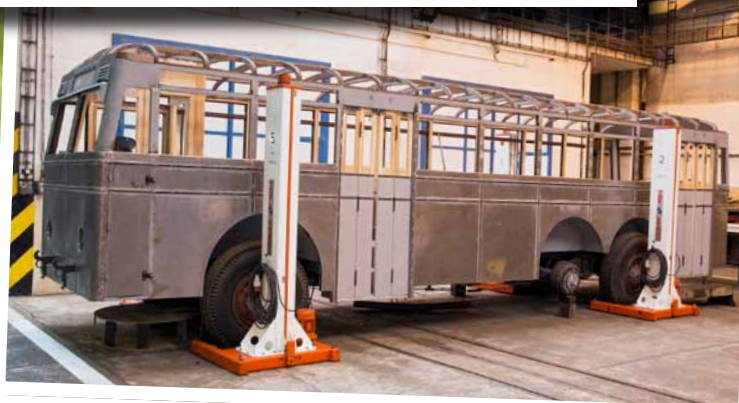
Ten samý trolejbus zachráněný v depozitáři nyní získává v hostivařských dílnách svou původní podobu.
